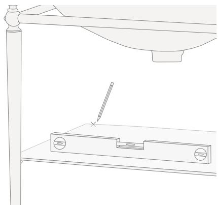
**16)** Retirer la tablette, faire les trous pour les supports dans le mur et y introduire les chevilles (I). Monter les supports et enfin la tablette.
