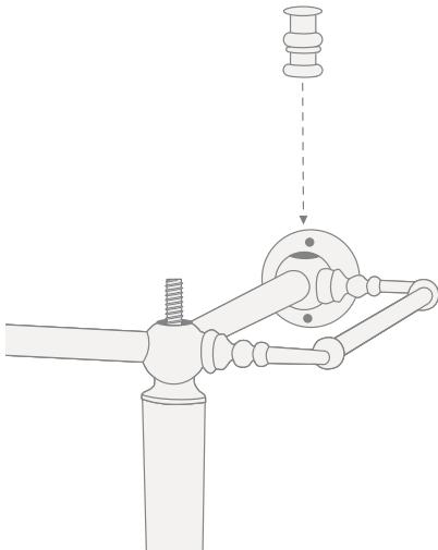
**10)** Monter sur la structure les supports réglables (G) plus éloignés du mur.
