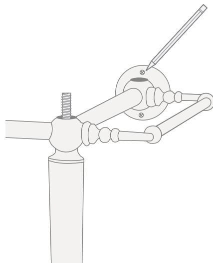
**8)** Отодвинуть конструкцию от стены и просверлить 4 отверстия, в соответствии с разметкой.
