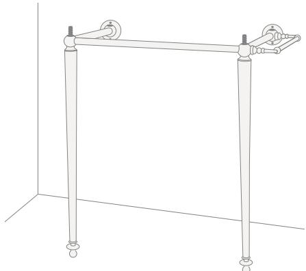
**5)** Vérifier la position de la structure par rapport au mur à l'aide d'un niveau (parallèlement et perpendiculairement).
