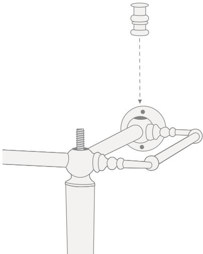
**10)** Montar sobre la estructura los soportes regulables (G) más alejados de la pared.
