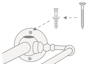
**9)** Montare sulla struttura i supporti fissi (H) per il lavabo più vicini al muro.
