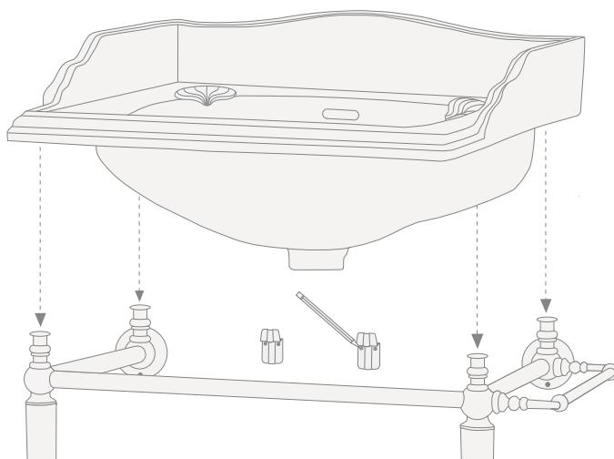
**13)** Llegados a este punto, es posible quitar el lavabo, realizar los agujeros en la pared respetando las marcas. Montar las pletinas de soporte del lavabo, fijándolas con los tornillos y tacos no proporcionado en dotación.
