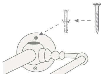
**9)** Montar sobre la estructura los soportes fijos para el lavabo (H) más cercanos a la pared.
