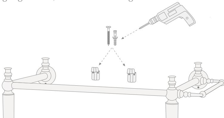
**14)** Positionieren Sie das Waschbecken erneut und setzen Sie den hinteren Teil zwischen Bügel und Wand.
