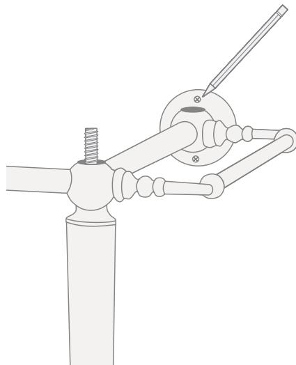
**7)** Rimuovere la struttura e eseguire i 4 fori in base alla tracciatura.
