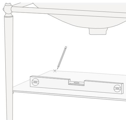
**12)** Убрать полку и просверлить отверстия для стенных опор. Вставить дюбели (!). Установить опоры и затем полку.
