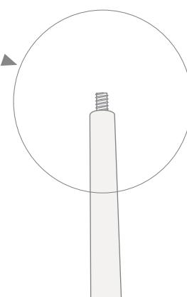
**4)** Закрепить опорные ножки (F), прикрутив их к выступающему из полых внутри ножек концу стержня (E).
