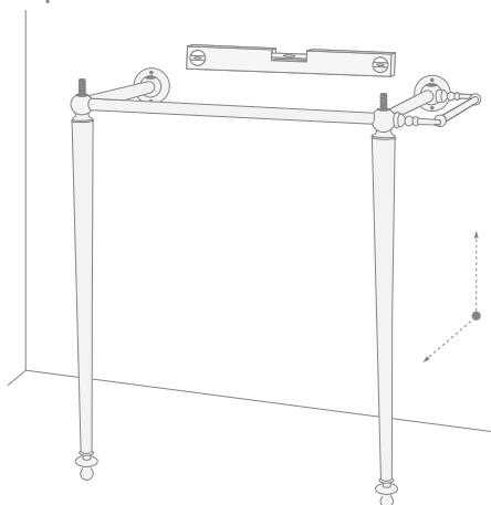
**7)** Наметить отверстия для крепления металлических накладок к стене.
