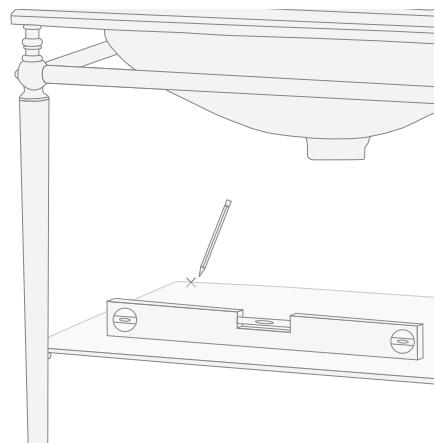
**16)** Legen Sie die Glasplatte wieder zur Seite, bohren Sie die Löcher in die Wand, führen Sie die Dübel ein und montieren Sie dann die Glasplatte.
