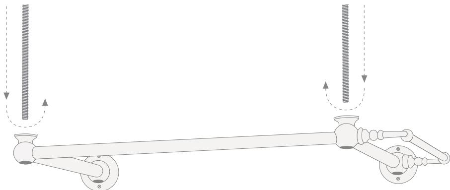
**2)** Надеть полые внутри ножки (D) основной конструкции на стержни с резьбой (E).
