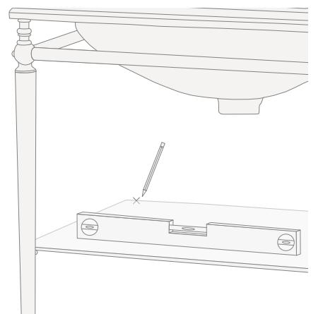
**16)** Rimuovere la mensola, eseguire le forature per i supporti a muro, inserire i tasselli (l) a muro. Montare i supporti e infine montare la mensola.
