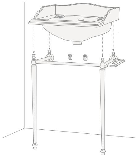
**15)** Legen Sie die Glasplatte auf die Auflagen an den Beinen und zeichnen Sie mit Hilfe einer Wasserwaage die Wandlöcher für die Halterungen an (J).
