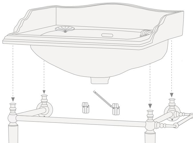
**13)** Il est alors possible de retirer le lavabo, de réaliser les trous en respectant les marques faites précédemment et d'y introduire ensuite les chevilles. Monter les étriers de soutien du lavabo en les fixant avec les vis. (attention : chevilles et vis non fournies.)
