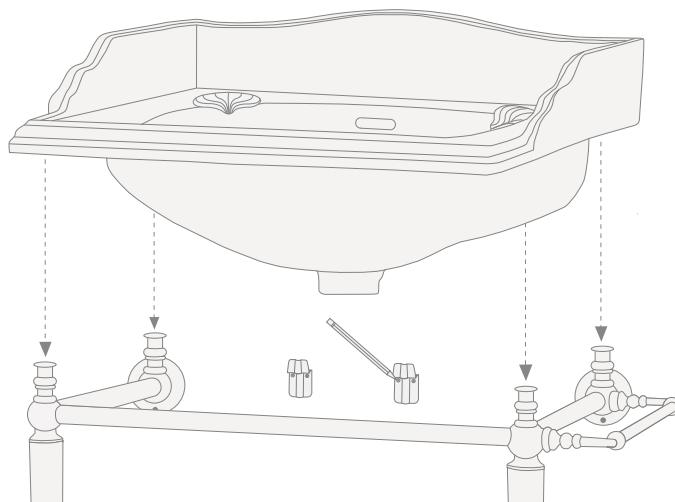
**13)** A questo punto è possibile rimuovere il lavabo, eseguire le forature a muro, rispettando le tracciature. Montare le staffe di supporto del lavabo, fissandole con viti e tasselli non forniti in dotazione.
