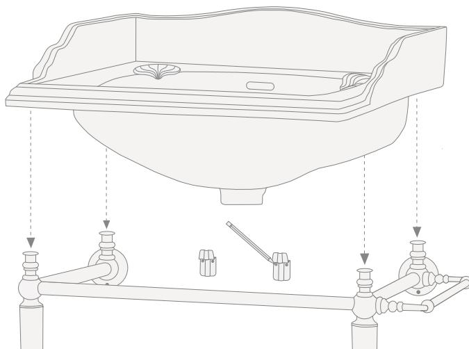
**13)** Nun kann das Waschbecken beiseite gestellt werden, um die Wandlöcher der Zeichnung entsprechend anzubringen. Jetzt werden die Tragebügel montiert. Dübel und Schrauben, die der Befestigung dienen, werden nicht mitgeliefert.
