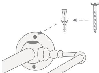
**9)** Befestigen Sie die feststehenden Halterungen (H) für das Waschbecken am Gestell, näher an der Wand.
