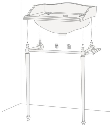
**15)** Colocar la repisa de cristal sobre los apoyos presentes en las patas y con la ayuda de un nivel marcar en la pared los agujeros para los soportes (J).
