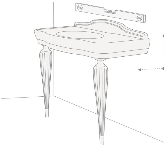
**7)** An der Wand Löcher markieren für die Anbringung der 4 Fixierungsdübel (I).
