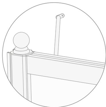
**21)** Marquer à l'aide d'un crayon les deux points sur le mur et sur le montant où la tige sera positionnée.
