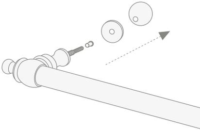
**29)** Den Griff (N) in die vorhandenen Bohrungen an der Scheibe der Duschtür einsetzen.
