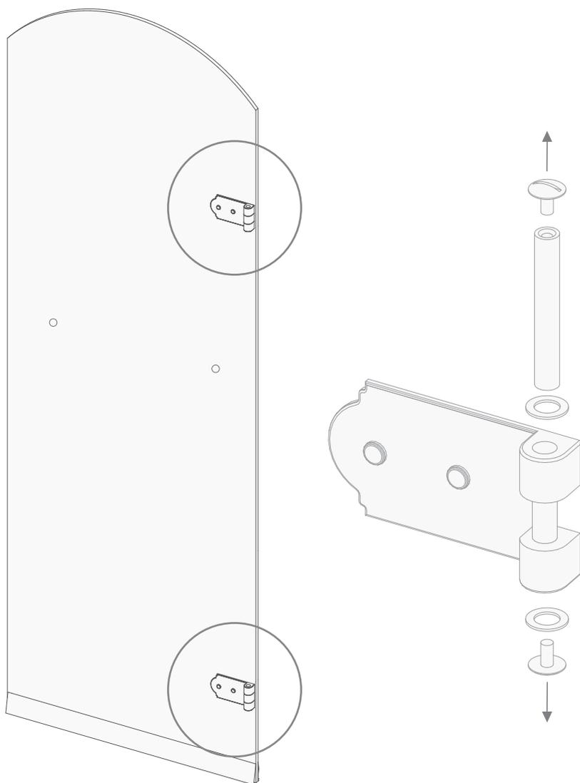
**16)** A ce point, positionner la porte (C) sur la structure montée au préalable, en vissant à nouveau les goujons des deux charnières qui ont été démontés au préalable.
