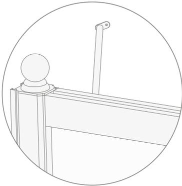
**21)** Mit einem Bleistift die beiden Punkte an der Wand und an der Säule anzeichnen, wo der Stab angebracht wird.
