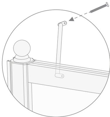
**25)** Закрепите распорку на стойке шурупом (I) с шайбой (H) и заглушкой (L).
