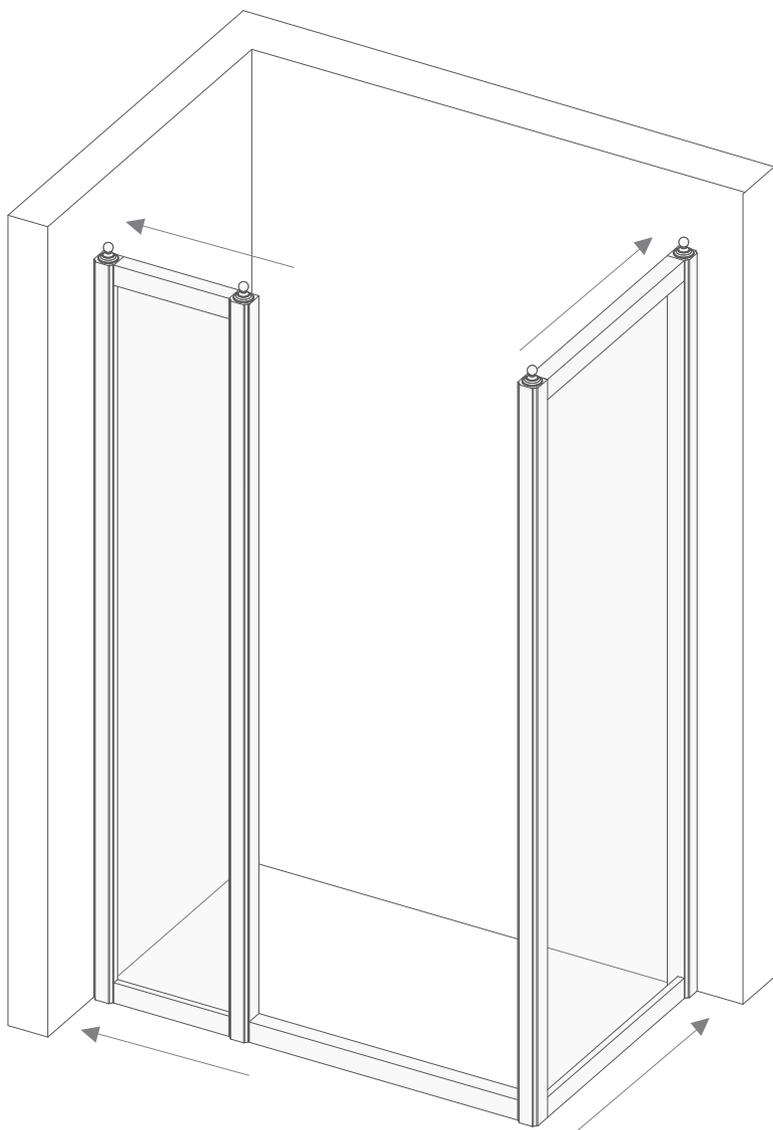
**13)** Coloque los tornillos (H), agujeree previamente, utilizando una broca de hierro ( $\varnothing$  2,5 mm) el montante del lado fijo de la puerta de la ducha (E: el que lleva bisagras).
