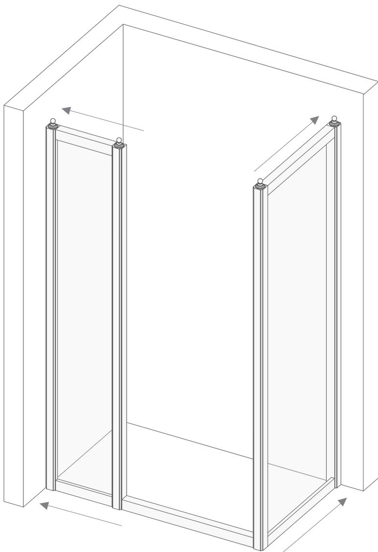
**13)** Установите шурупы (Н), предварительно просверлив отверстия сверлом для металла (Ø 2,5 мм), в стойке неподвижной части двери душа (Е: стойка с петлями).
