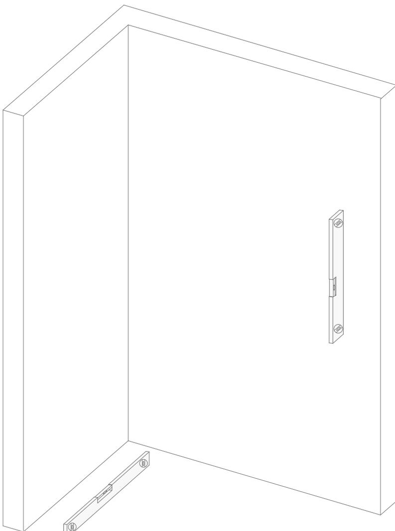
2) Die Fußleiste (D) an der festen Seite der Duschtür (B) einsetzen.
