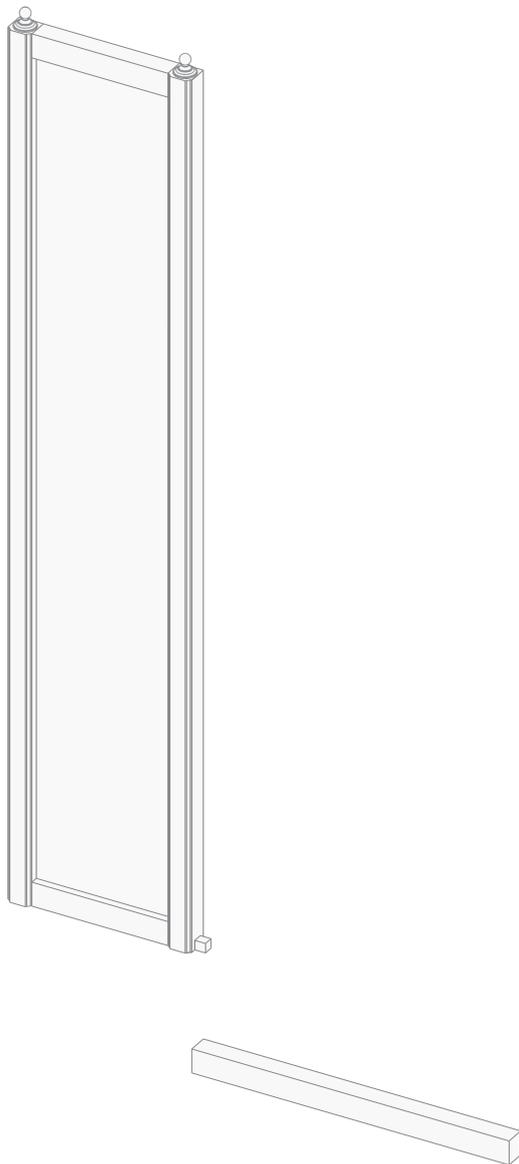
**3)** Укрепите порог при помощи поставленных в комплекте шурупов к неподвижной стороне двери душа (место показано на нижеприведенном рисунке).
