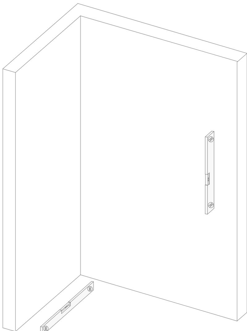
2) Coloque el zócalo (D) en el lado fijo (B) de la puerta de la ducha.
