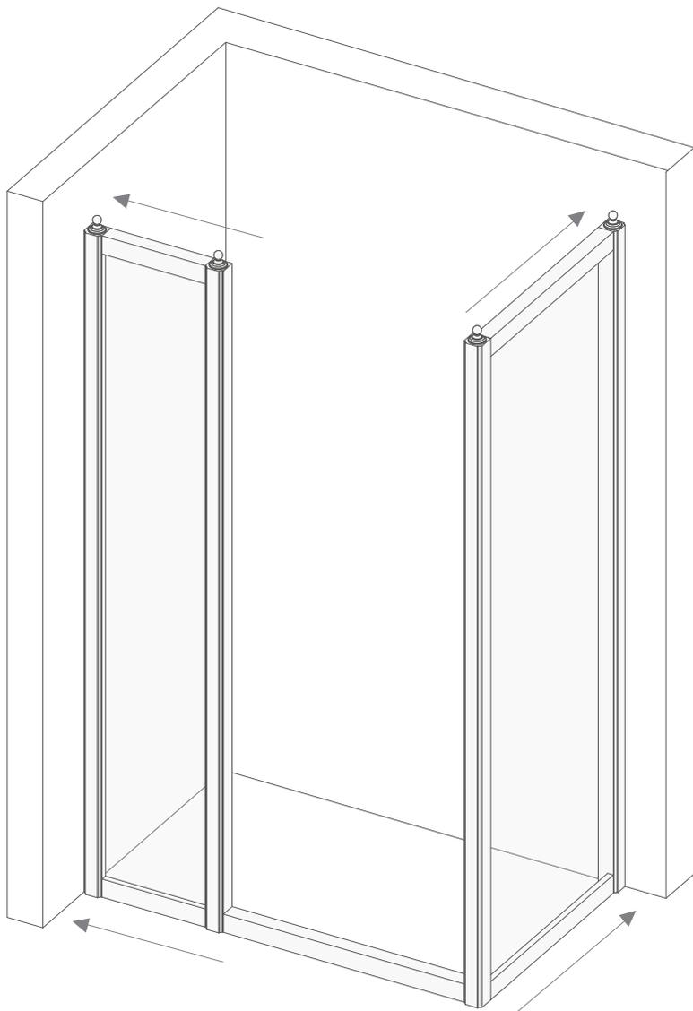
**6)** Segnare con una matita i due punti preforati, in alto e in basso, all'interno di entrambi i profili (A).
