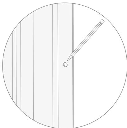
**7)** Enlever les profils compensateurs et percer à hauteur des points marqués.
