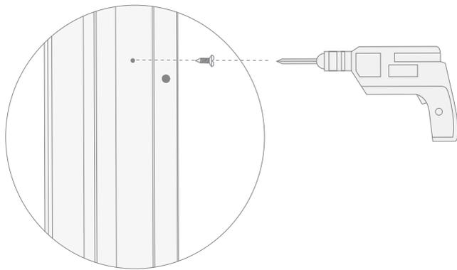
**19)** Вставьте поставленные в комплекте заглушки (L: белые или черные на выбор) для прикрытия отверстий установки саморезных шурупов.
