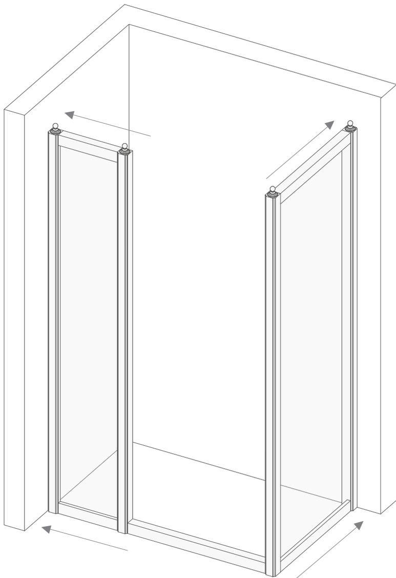
**6)** Mit einem Bleistift die beiden vorgebohrten Punkte innerhalb der beiden Profile (A) oben und unten kennzeichnen.
