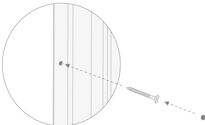
**11)** Вставьте поставленные в комплекте заглушки (L: белые или черные на выбор) для закрытия отверстий установки саморезных шурупов.
