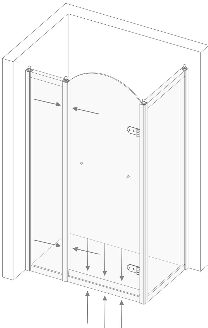
**18)** Mit perfekt regulierter Tür kann man jetzt die Schrauben (H) einsetzen und mit einer Eisenspitze ( $\varnothing$  2,5 mm) die Säule der anderen festen Seite der Duschtür vorbohren (B).
