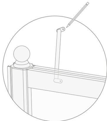
**22)** Forare, con la punta a muro il muro (punto A) e con la punta a ferro il montante superiore del lato fisso (punto B).
