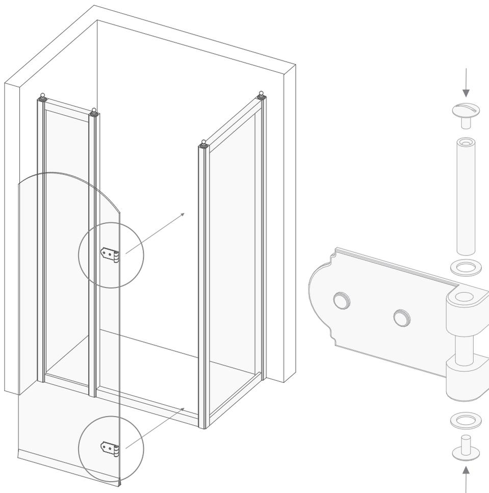
**17)** Regule la estructura de la puerta de la ducha, en horizontal y en vertical, en los puntos indicados en la figura de abajo.
