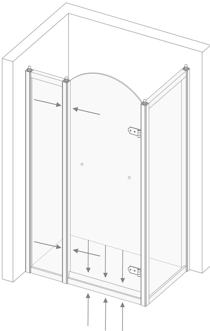
**18)** Con la porta perfettamente regolata adesso è possibile posizionare le viti (H), pre-forare, con una punta a ferro ( $\varnothing$  2,5 mm) il montante dell'altro lato fisso della cabina doccia (B).
