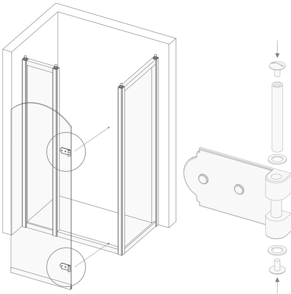
**17)** Regolare la struttura della porta doccia, in orizzontale e in verticale, nei punti indicati nella figura sottostante.
