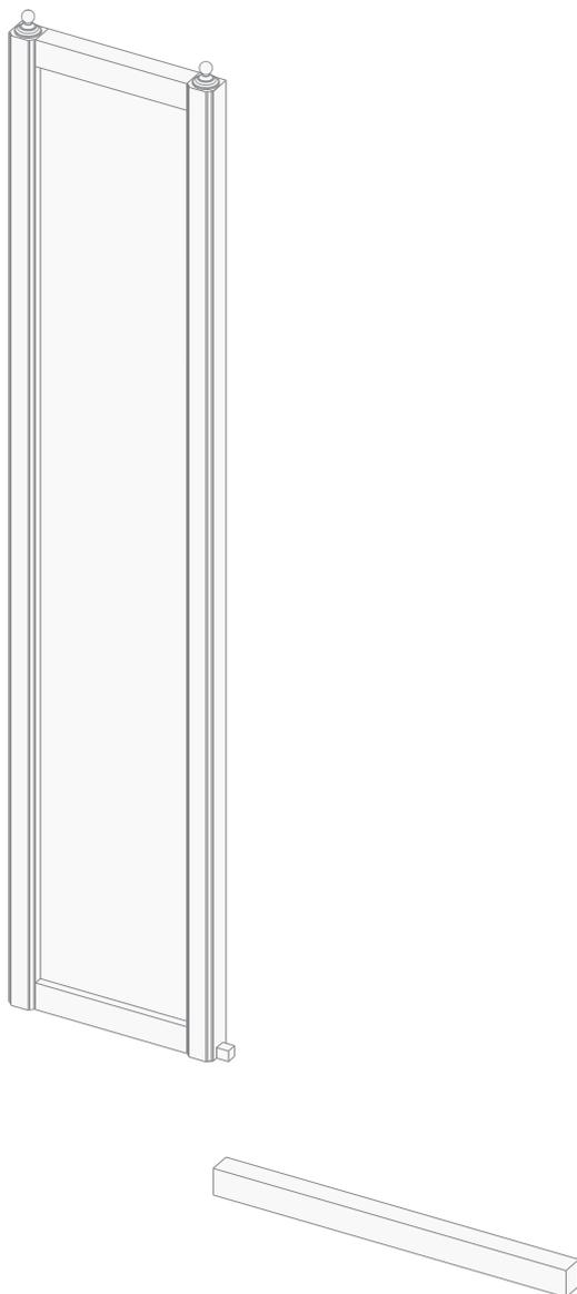
**3)** Fixer, au moyen de la vis fournie, le garde-pieds au côté fixe de la porte de douche (dans le point indiqué dans la figure ci-dessous).
