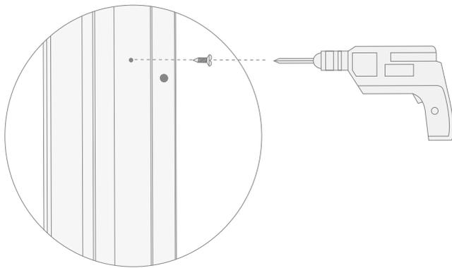
**19)** Posizionare i tappi in dotazione (L: a scelta tra bianchi e neri) per coprire i fori dove sono state inserite le viti autofilettanti.
