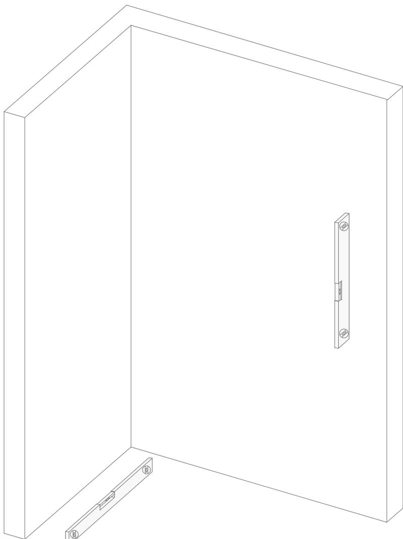
2) Вставьте порог (D) в неподвижную часть (B) двери кабины душа.
