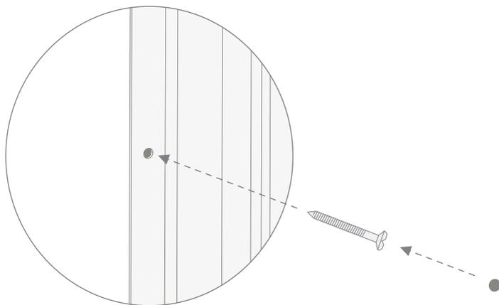
**11)** Posizionare i tappi in dotazione (L: a scelta tra bianchi o neri) per coprire i fori dove sono state inserite le viti autofilettanti.
