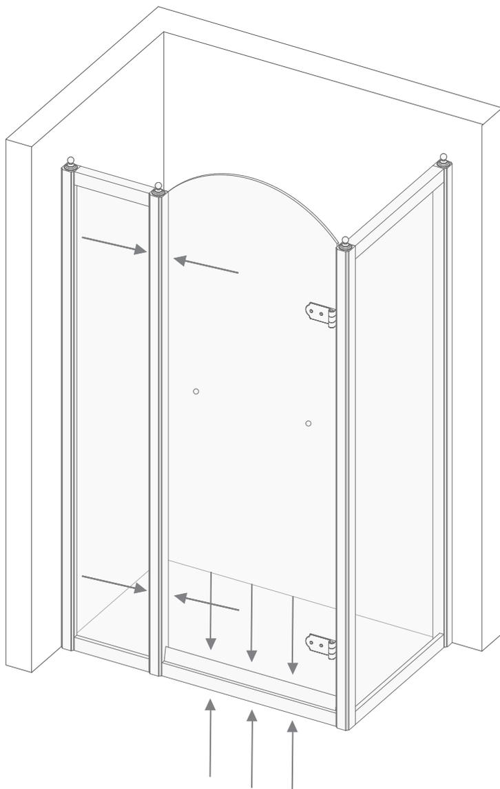
**18)** После регулировки двери можно установить шурупы (H) и засверлить сверлом по металлу ( $\varnothing$  2,5 мм) отверстия в другой неподвижной части двери душа (B).
