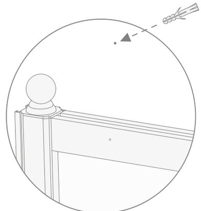
**24)** Die Stange mit der Schraube an Punkt A an die Wand schrauben.
