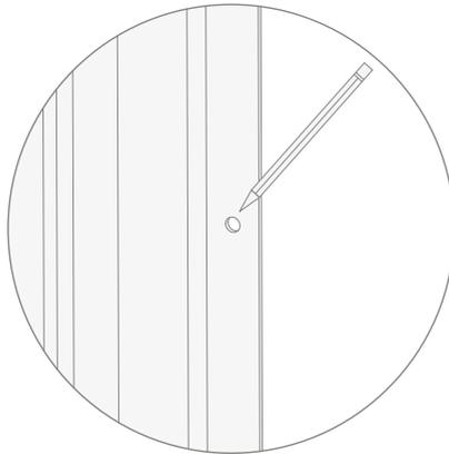
**7)** Die Ausgleichsprofile abnehmen und an den vorher angezeichneten Punkten Löcher bohren.
