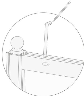
**22)** Просверлите сверлом для стены отверстие в стене (точка A), и сверлом по металлу, отверстие в верхней стойке неподвижной стороны (точка B).
