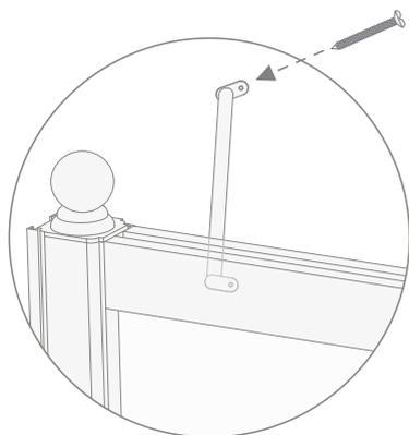
**25)** Die Stange mit der Unterlegscheibe (I), der Schraube (H) und dem Stopfen (L) an der Säule befestigen.
