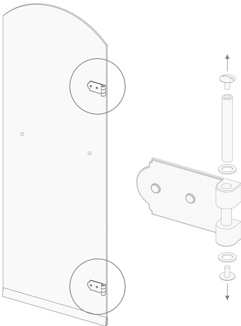
**16)** После этого можно установить дверь(С) на ранее собранную структуру снова ввернув ранее снятые оси обеих петель.
