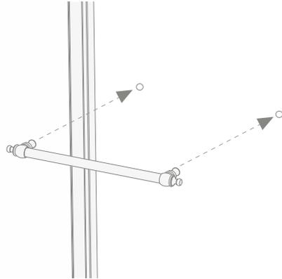
**30)** Nun kann der Griff von innen blockiert werden, indem man die vorher abgeschraubten Teile von beiden Seiten wieder anschraubt.
