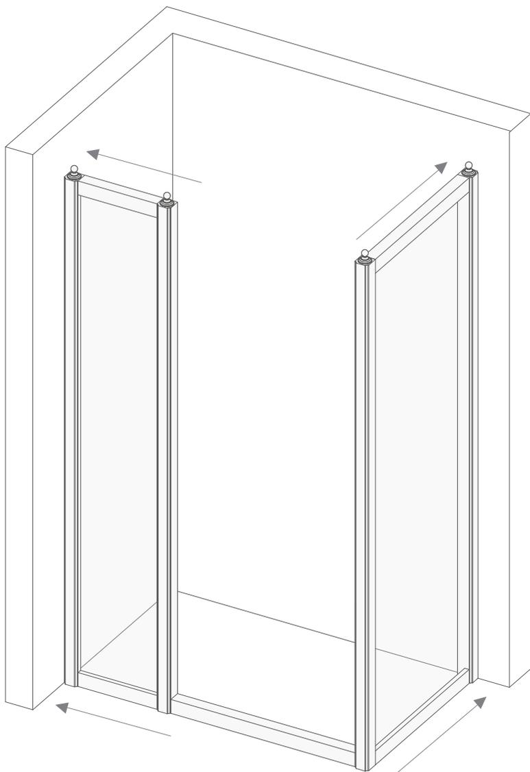
**6)** Marque con un lápiz los dos puntos perforados, uno en la parte de arriba y otro en la de abajo, dentro de ambos perfiles (A).
