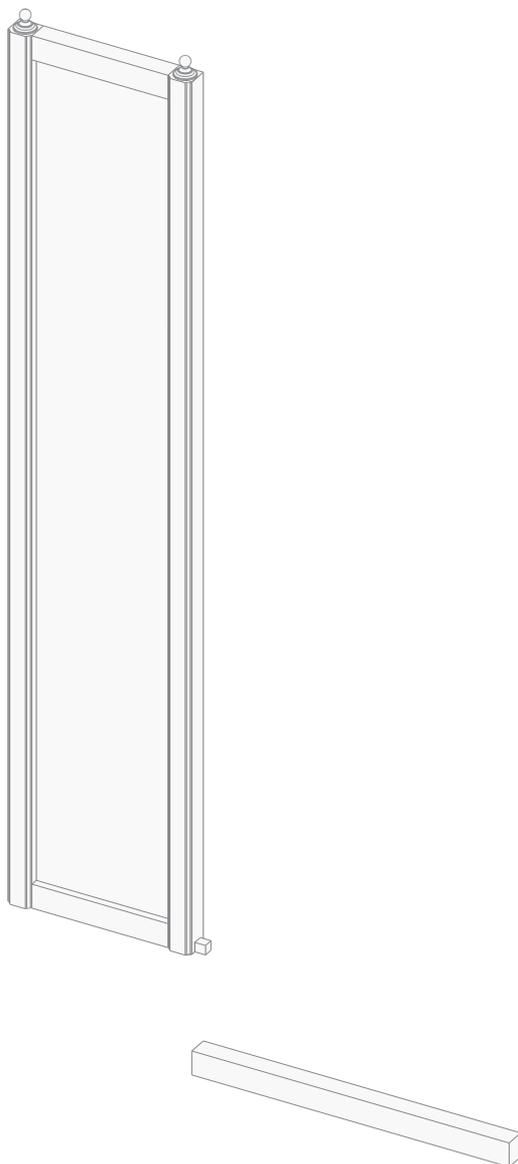
**3)** Mit der mitgelieferten Schraube die Fußleiste an der festen Seite der Duschtür befestigen (die genaue Stelle ist in der Abbildung gekennzeichnet).
