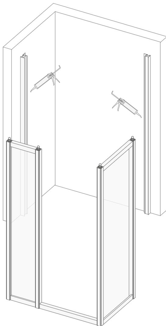
**10)** Укрепите на стене дверь душа при помощи вложенных в комплект стальных шурупов (F) до полного крепления их к стенам.
