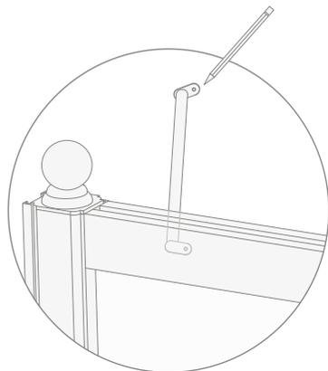
**22)** Percer le mur (point A) avec la pointe à mur prévue à cet effet et avec la pointe à fer le montant supérieur du côté fixe (point B).
