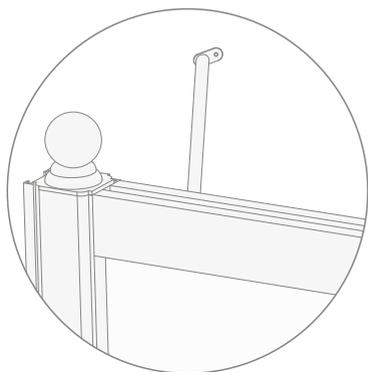
**21)** Отметьте карандашом положение двух точек на стене и на стойке в месте установки распорки.
