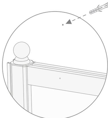
**24)** Fissare l'asta con la vite nel punto A sul muro.
