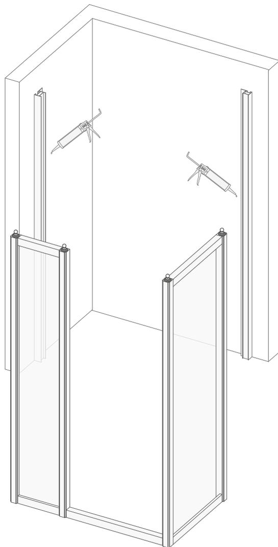
**10)** Fije en la pared la puerta de la ducha utilizando los tornillos de acero proporcionados (F), hasta que quede completamente fijada en las paredes.
