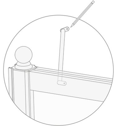
**22)** Mit einer Steinspitze ein Loch in der Wand bohren (Punkt A), dann mit der Eisenspitze die obere Säule der festen Seite durchbohren (Punkt B).
