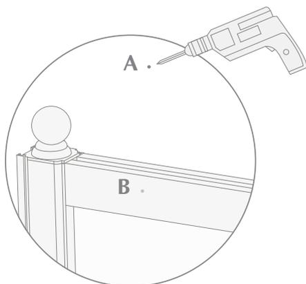
**23)** Вставьте пробку в отверстие в стене в ранее отмеченной точке A.
