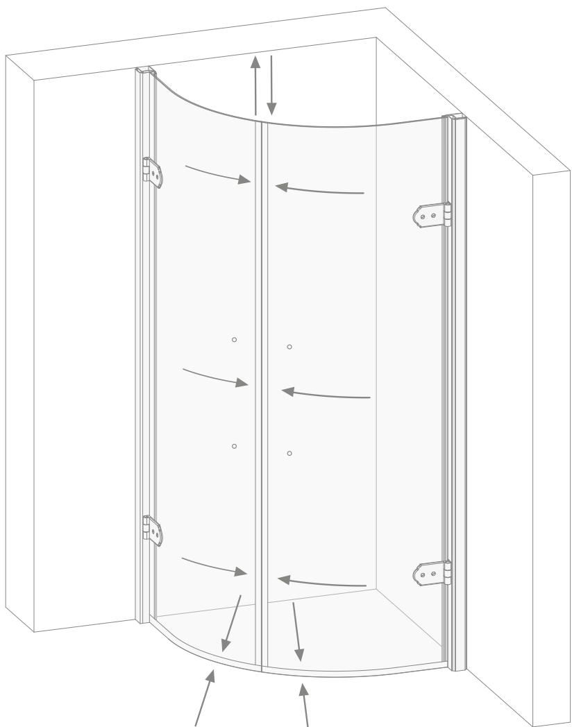
**11)** Haga dos agujeros, utilizando una broca de hierro, en el montante de la primera puerta de la ducha en dos puntos, uno en la parte de arriba, y otro en la de abajo.
