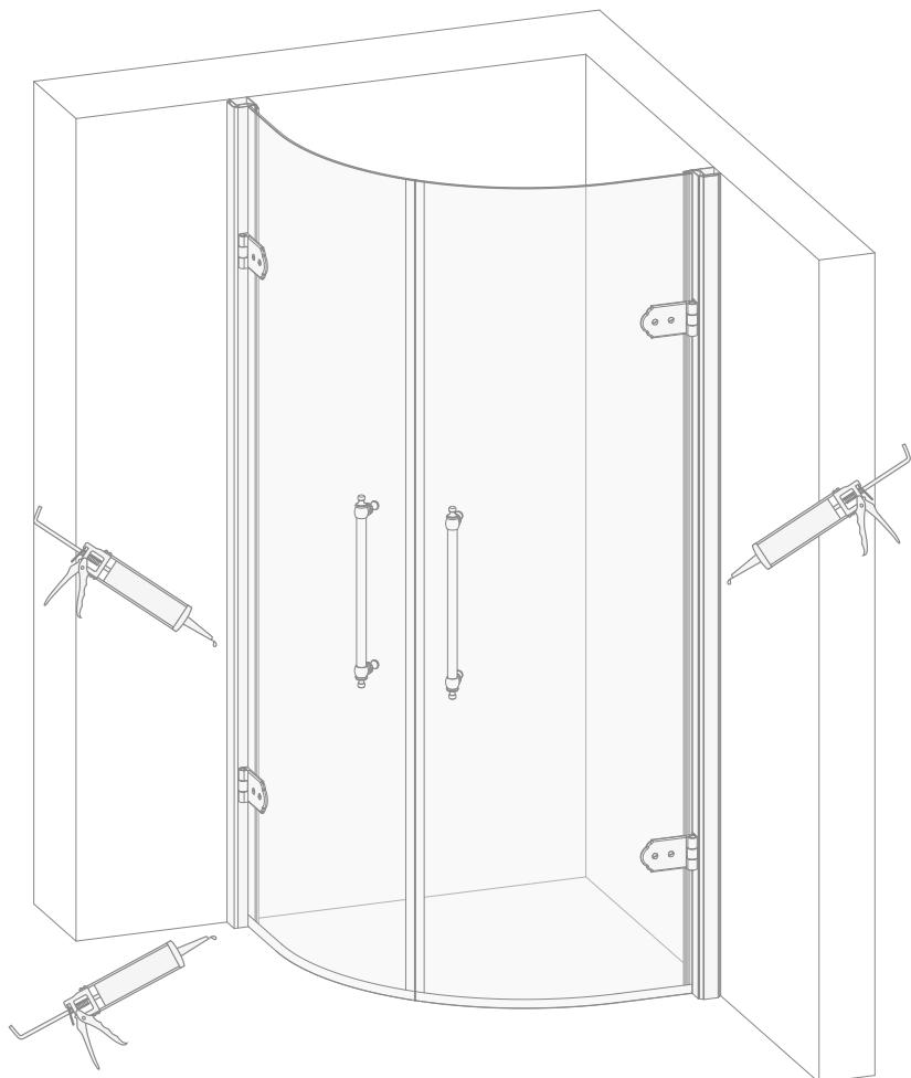
20) При помощи бумаги и спирта, тщательно удалить излишки силикона со стен и со структуры душа.
