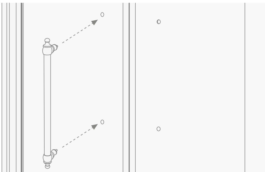
16) Теперь можно зафиксировать ручку изнутри путем завинчивания ранее снятых с обеих сторон частей.
