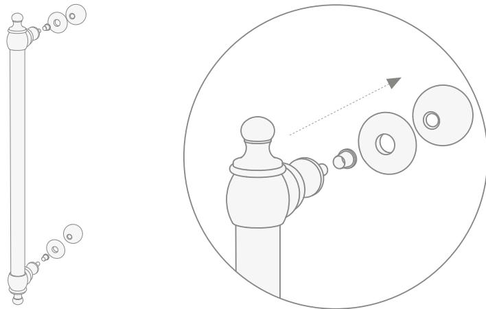
**15)** Den Griff (H) in die vorhandenen Bohrungen an der Scheibe der Duschtür einsetzen.
