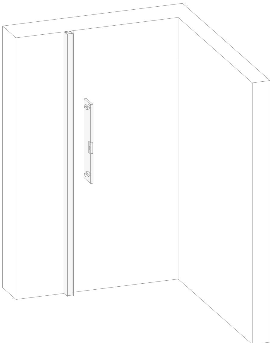
**3)** Segnare con una matita i due punti, in alto e in basso, all'interno del profilo compensatore (A).
