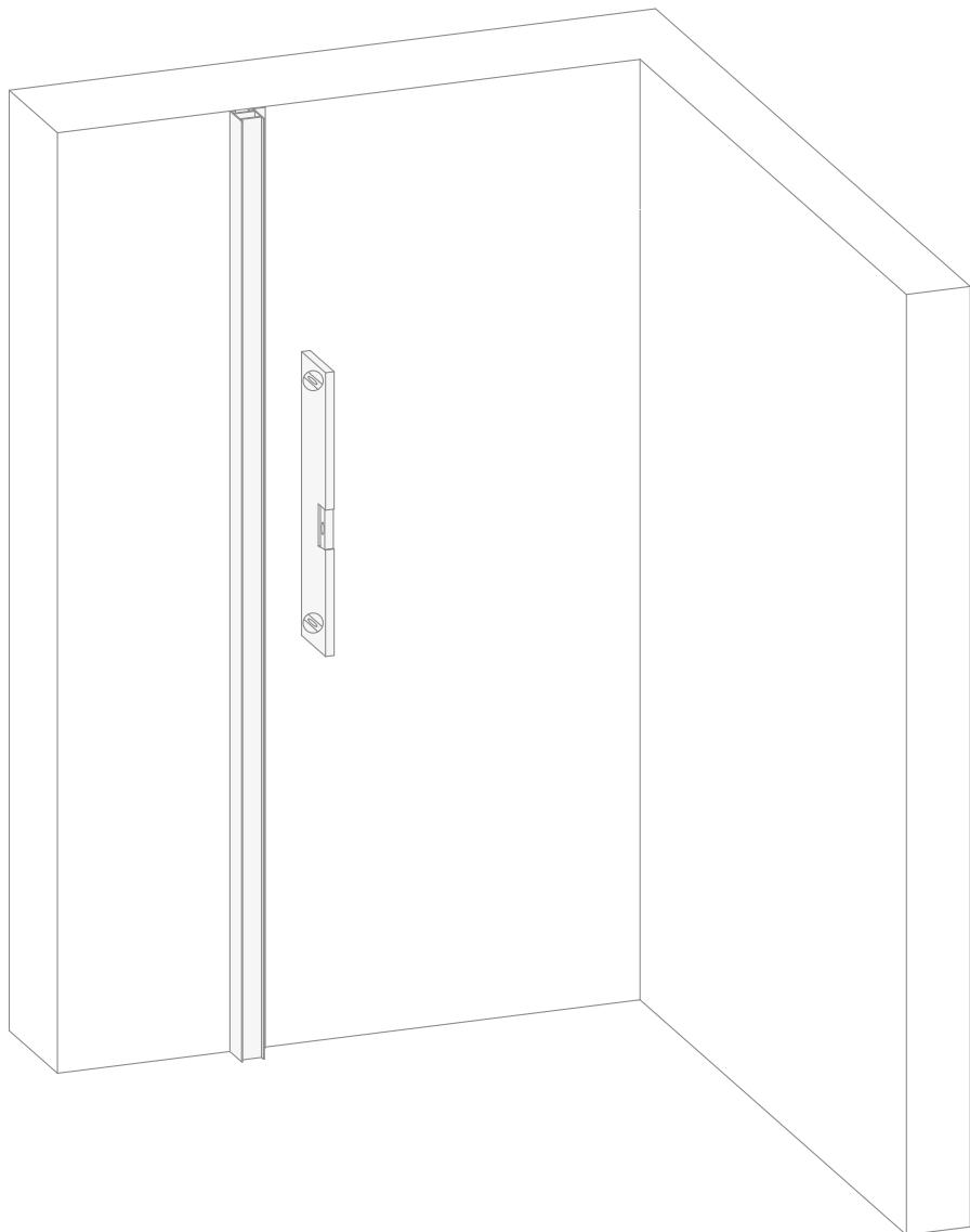
**3)** Marque con un lápiz los dos puntos, por arriba y por abajo, en la parte interna del perfil compensador.
