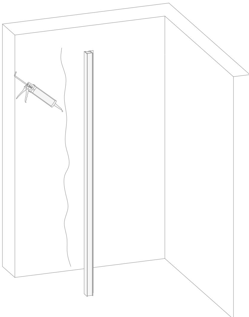
7) Прикрепите к стене компенсационный профиль (A) при помощи, вложенных в комплект, стальных шурупов (C) и прикрепите его окончательно к стене.
