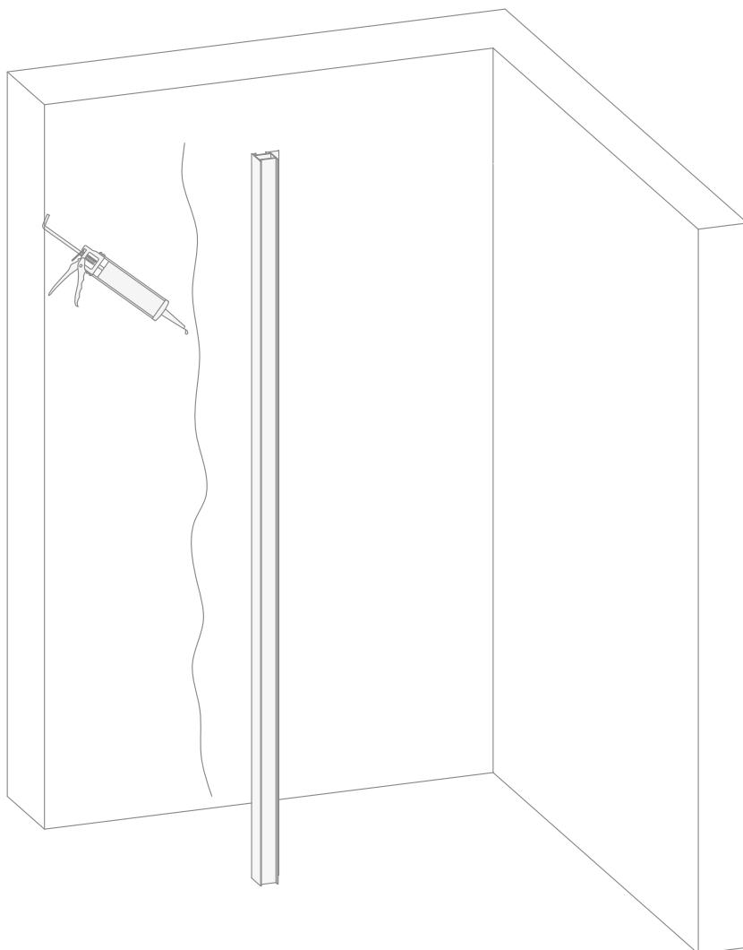
**7)** Fije en la pared el perfil compensador (A) utilizando los tornillos de acero proporcionados (C) hasta que quede bien fijado en la pared.
