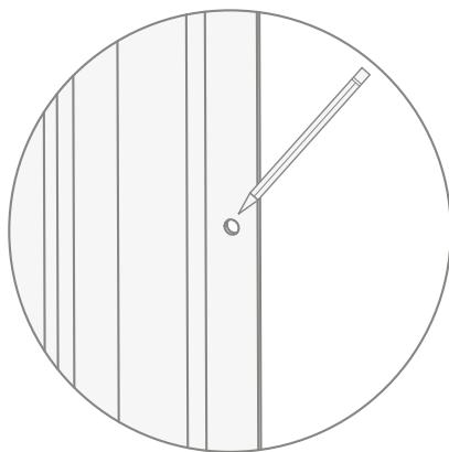
**4)** Das Ausgleichsprofil abnehmen und an den beiden vorher markierten Punkten Löcher bohren.
