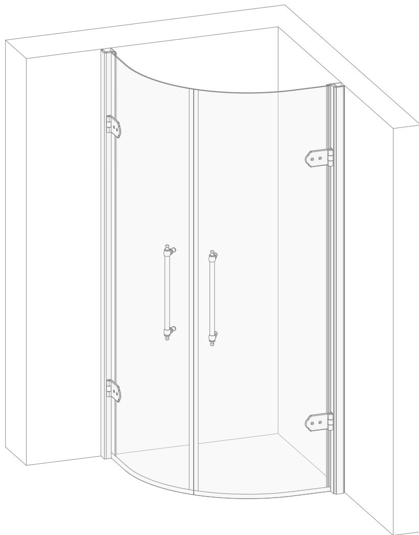
**19)** Nun bei Bedarf die Aluminiumprofile an der Wand und der Duschwanne mit Silikon versiegeln, und zwar nur von außen.
