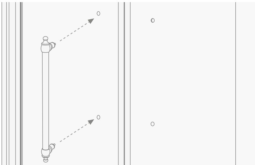
**16)** Nun kann der Griff von innen blockiert werden, indem man die vorher abgeschraubten Teile von beiden Seiten wieder anschraubt.
