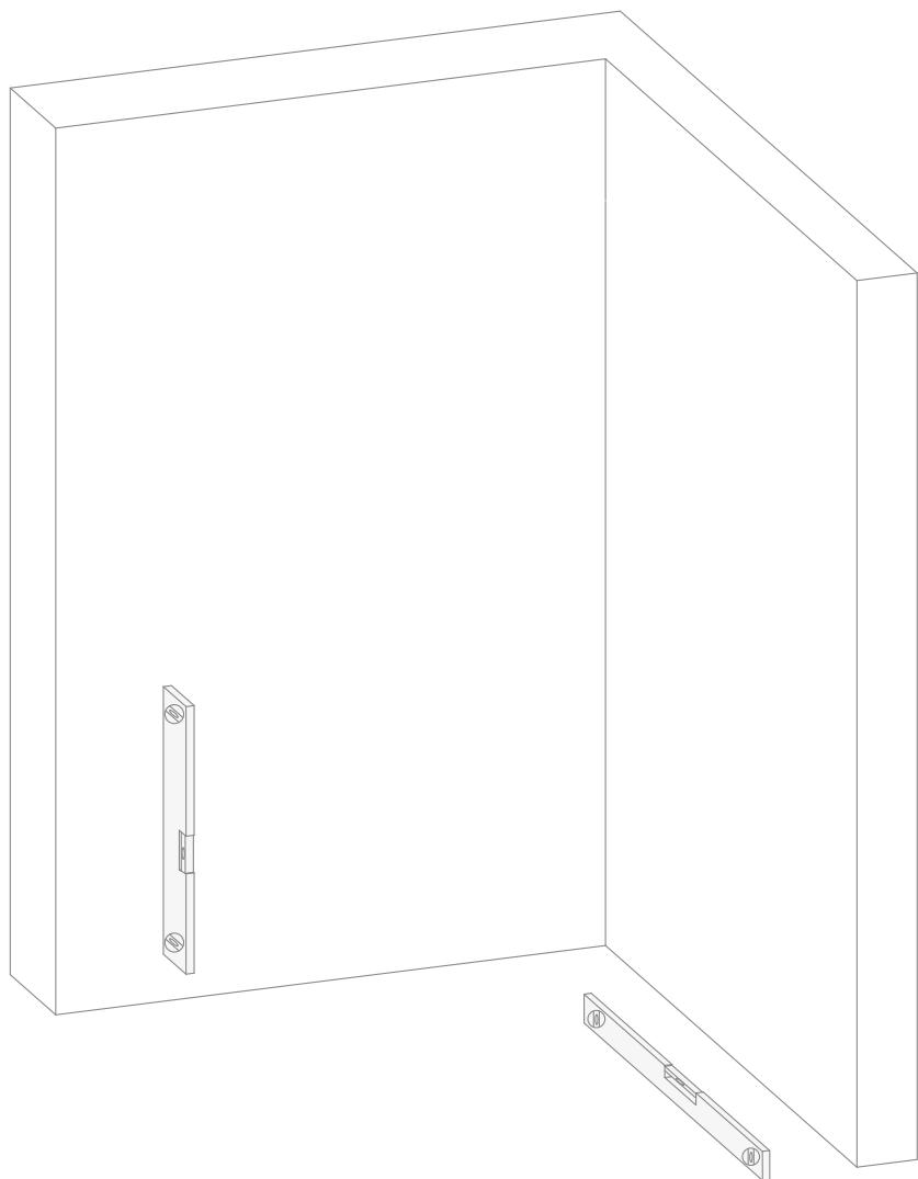
**2)** Posizionare alla parete il primo profilo compensatore (A) già preforato. Accertarsi, con l'aiuto di una livella, che esso sia perfettamente in bolla.
