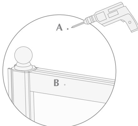
**23)** Den Dübel in den vorher angezeichneten Punkt A an der Wand einsetzen.
