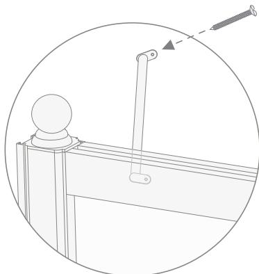
**25)** Fissare l'asta con la rondella (H), la vite (G) e il tappo (I) al montante.
