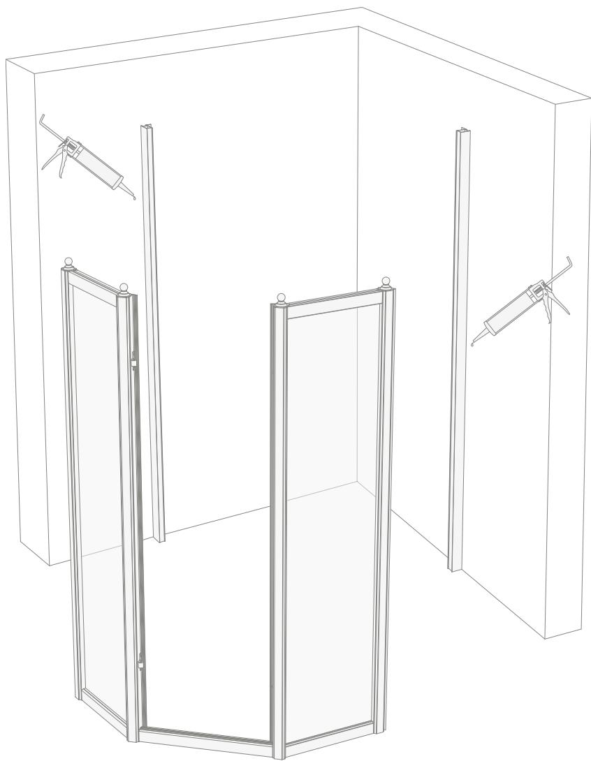
**10)** Fissare alla parete la porta doccia tramite le viti in acciaio fornite (E) fino a bloccarla completamente alle pareti.
