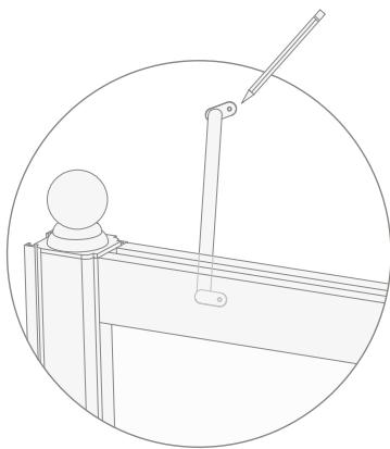
**22)** Mit einer Steinspitze ein Loch in der Wand bohren (Punkt A), dann mit der Eisenspitze die obere Säule der festen Seite durchbohren (Punkt B).
