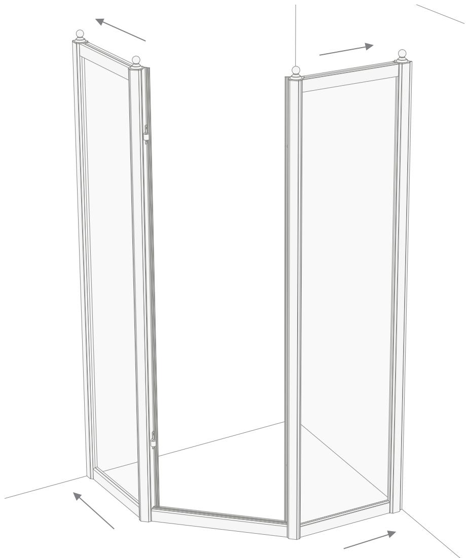
**6)** Segnare con una matita i due punti preforati, in alto e in basso, all'interno di entrambi i profili (A).
