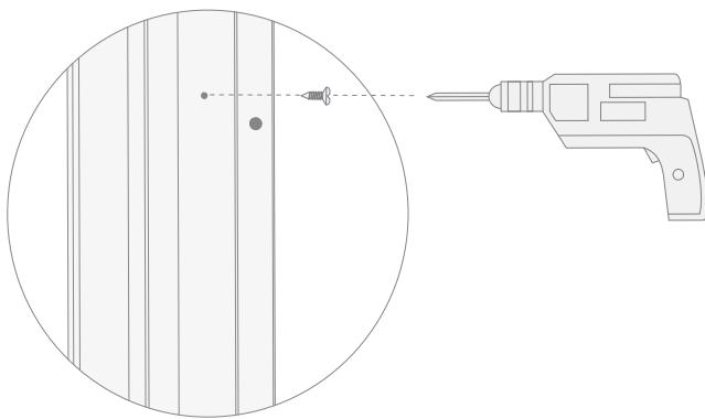
**19)** Posizionare i tappi in dotazione (H: a scelta tra bianchi e neri) per coprire i fori dove sono state inserite le viti autofilettanti.
