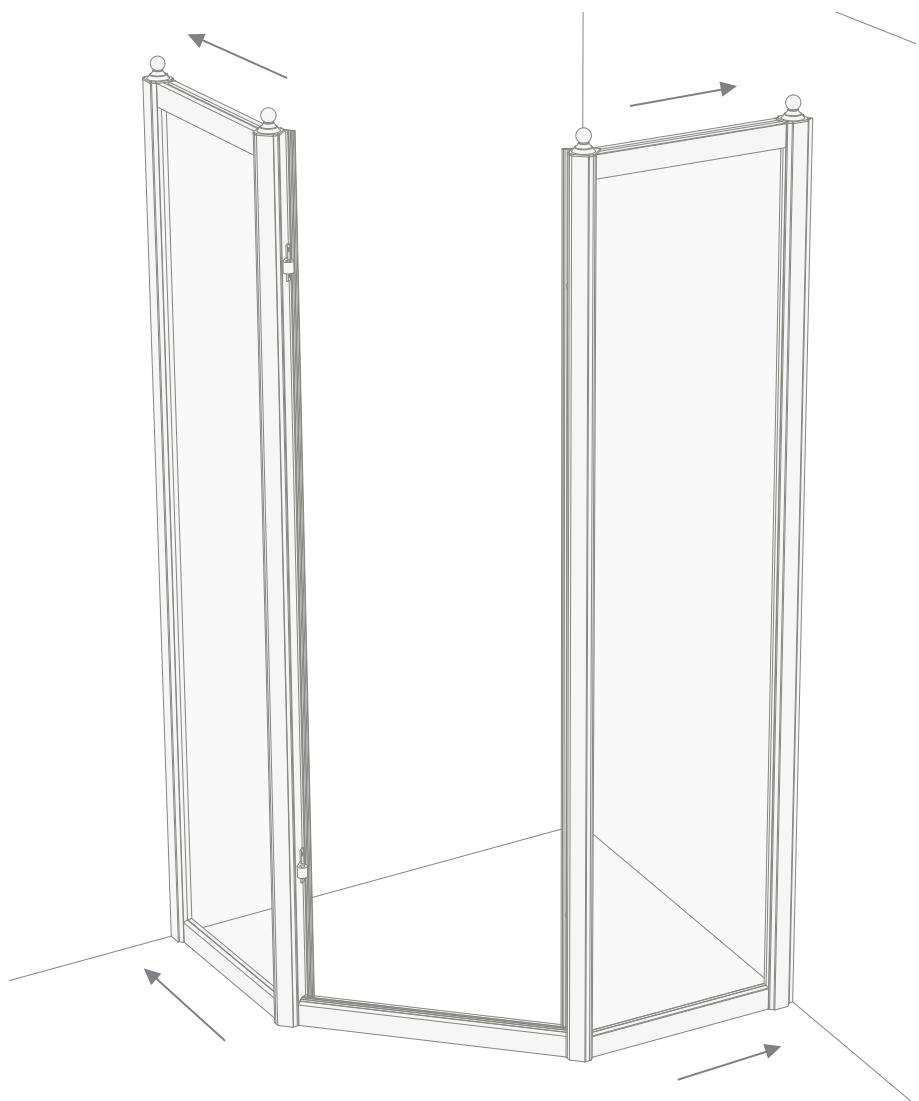
**13)** Coloque los tornillos (G), agujereee previamente, utilizando una broca de hierro ( $\varnothing$  2,5 mm) el montante del lado fijo de la puerta de la ducha (el que lleva bisagras).
