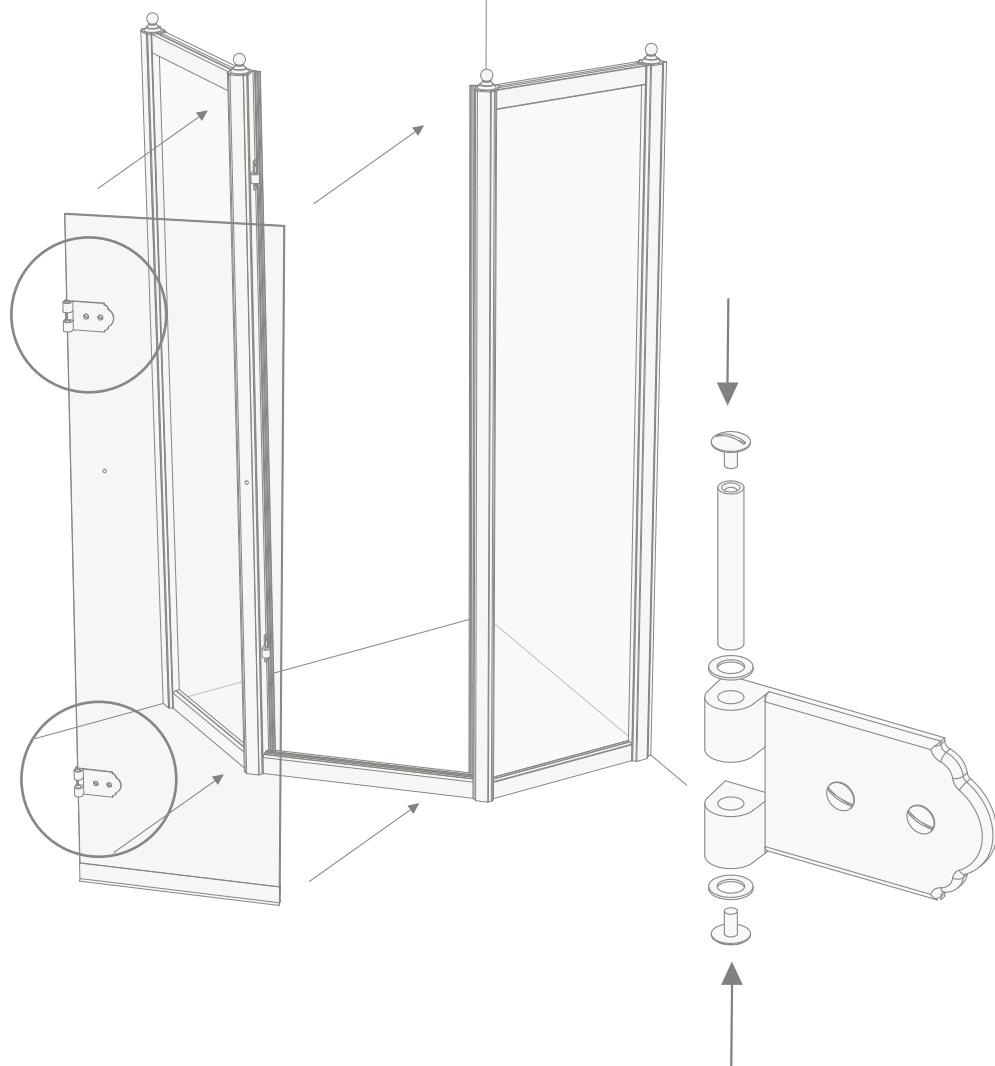
**17)** Regule la estructura de la puerta de la ducha, en horizontal y en vertical, en los puntos indicados en la figura de abajo.
