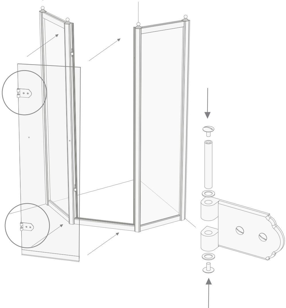
**17)** Regolare la struttura della porta doccia, in orizzontale e in verticale, nei punti indicati nella figura sottostante.
