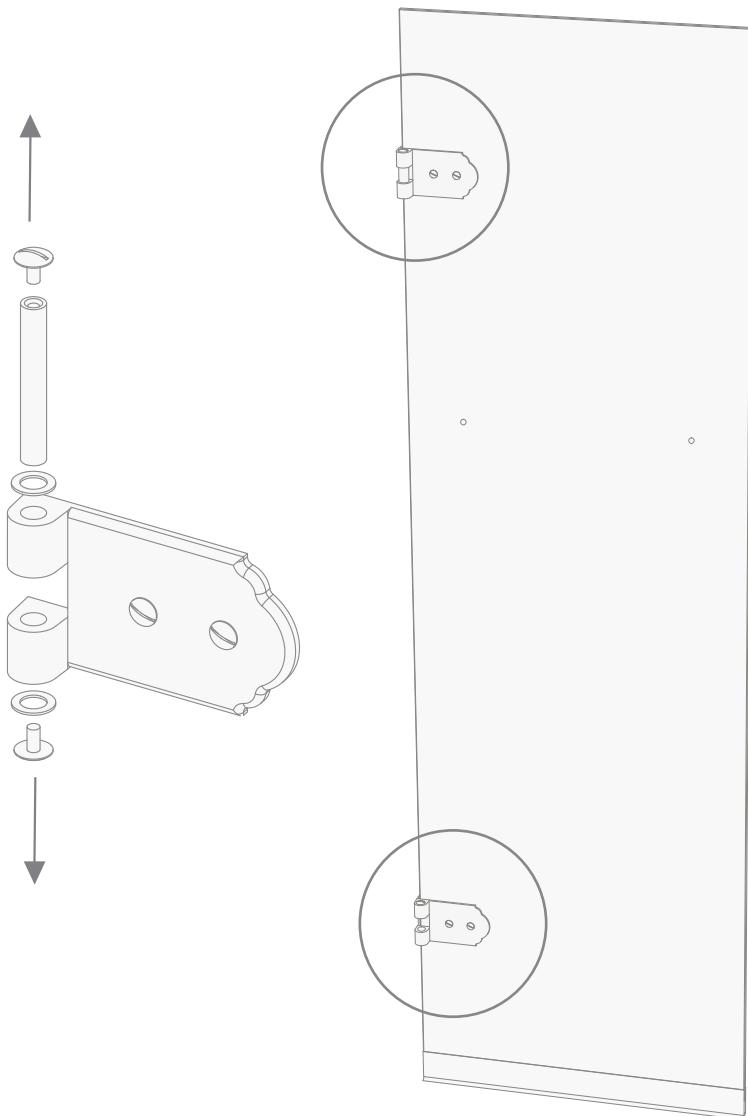
**16)** A ce point, positionner la porte (C) sur la structure montée au préalable, en vissant à nouveau les goujons des deux charnières qui ont été démontés au préalable.
