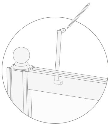
**22)** Percer le mur (point A) avec la pointe à mur prévue à cet effet et avec la pointe à fer le montant supérieur du côté fixe (point B).
