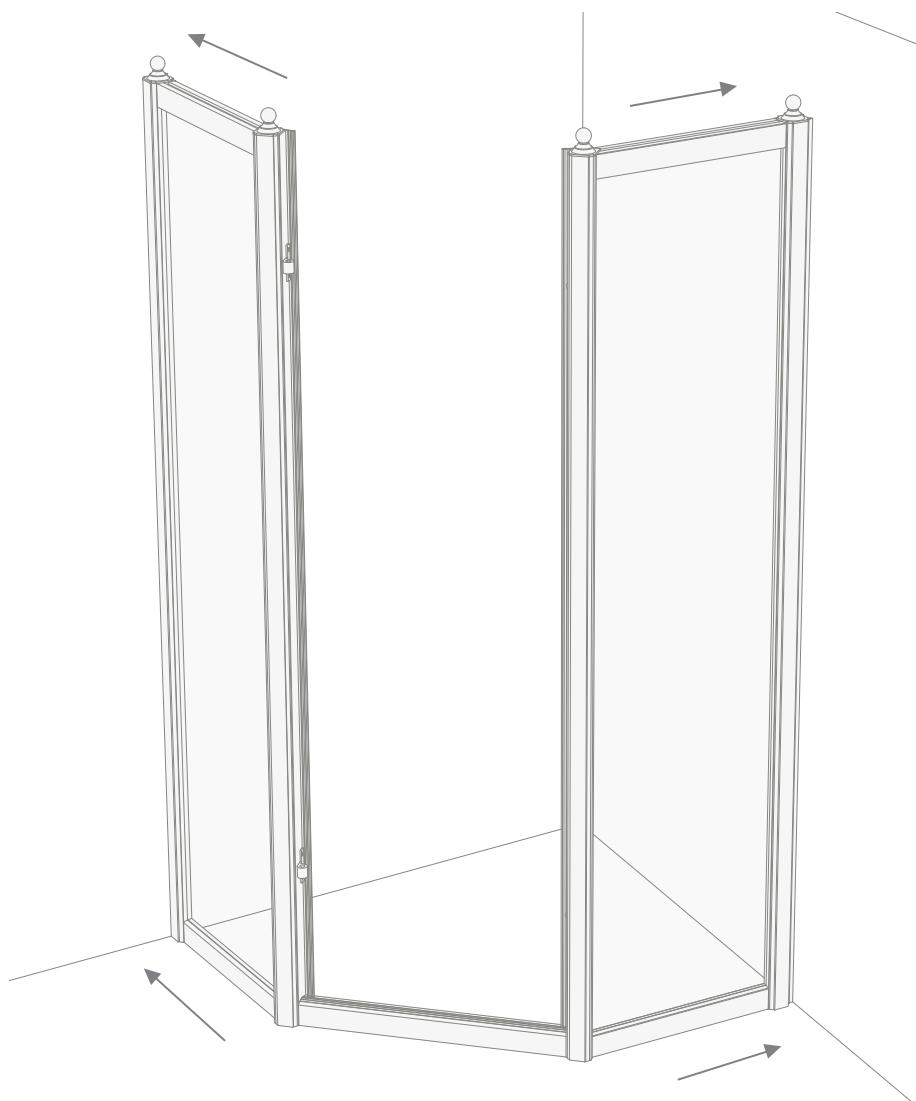
**13)** Установите шурупы (G), предварительно просверлив отверстия сверлом для металла ( $\varnothing$  2,5 мм), в стойке неподвижной части двери душа (стойка с петлями).
