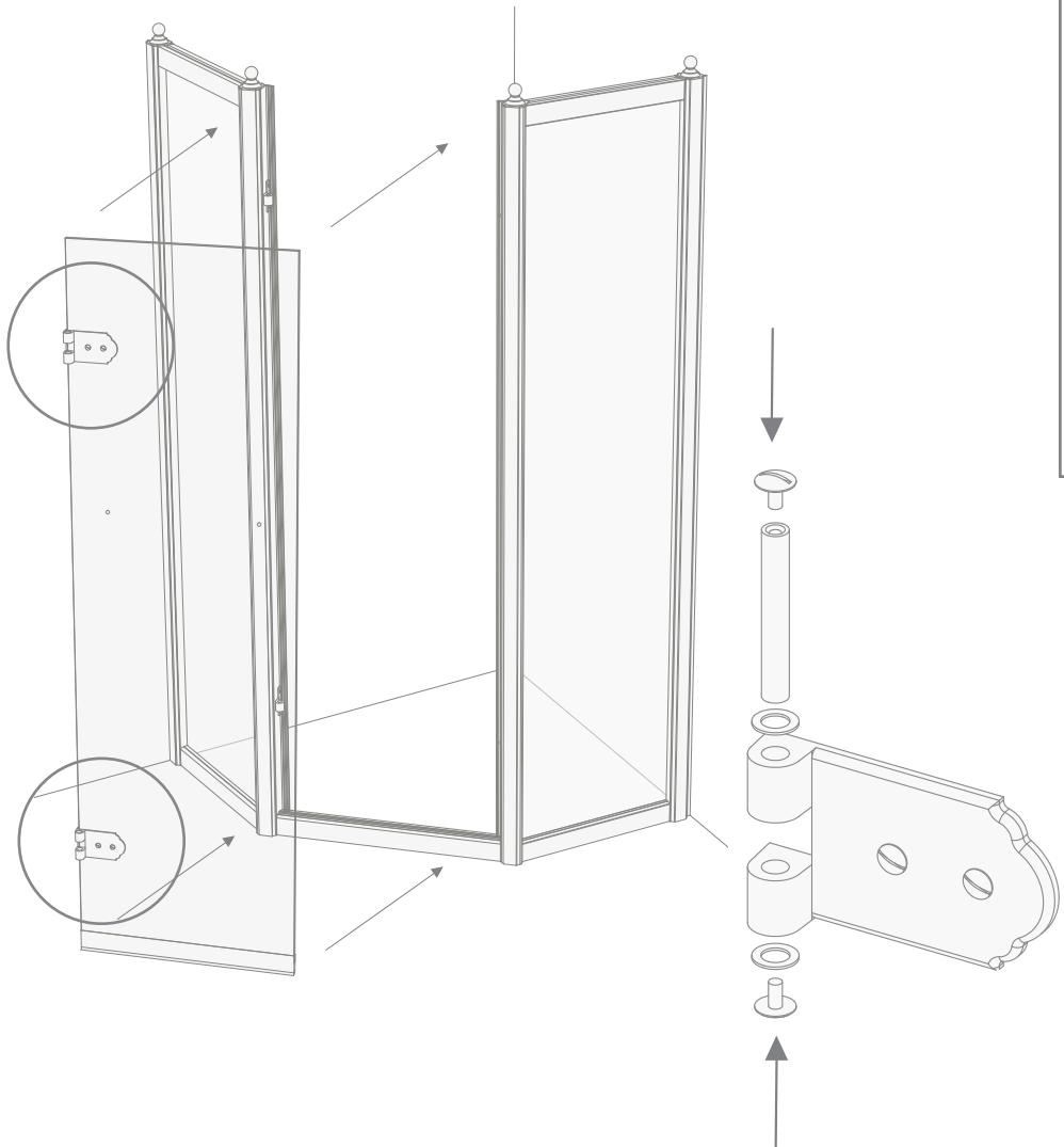
**17)** Den Aufbau der Duschtür horizontal und vertikal an den Stellen regulieren, die in der Abbildung unten angegeben sind.
