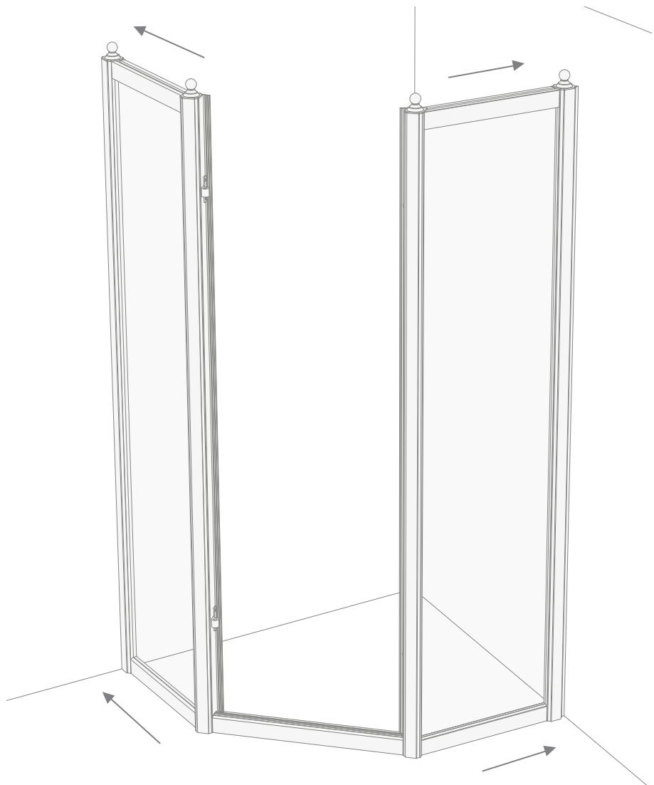
**6)** Marque con un lápiz los dos puntos perforados, uno en la parte de arriba y otro en la de abajo, dentro de ambos perfiles (A).
