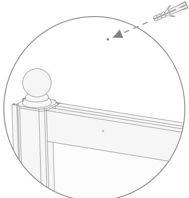
**24)** Fixer la tige au moyen de la vis dans le point A sur le mur.
