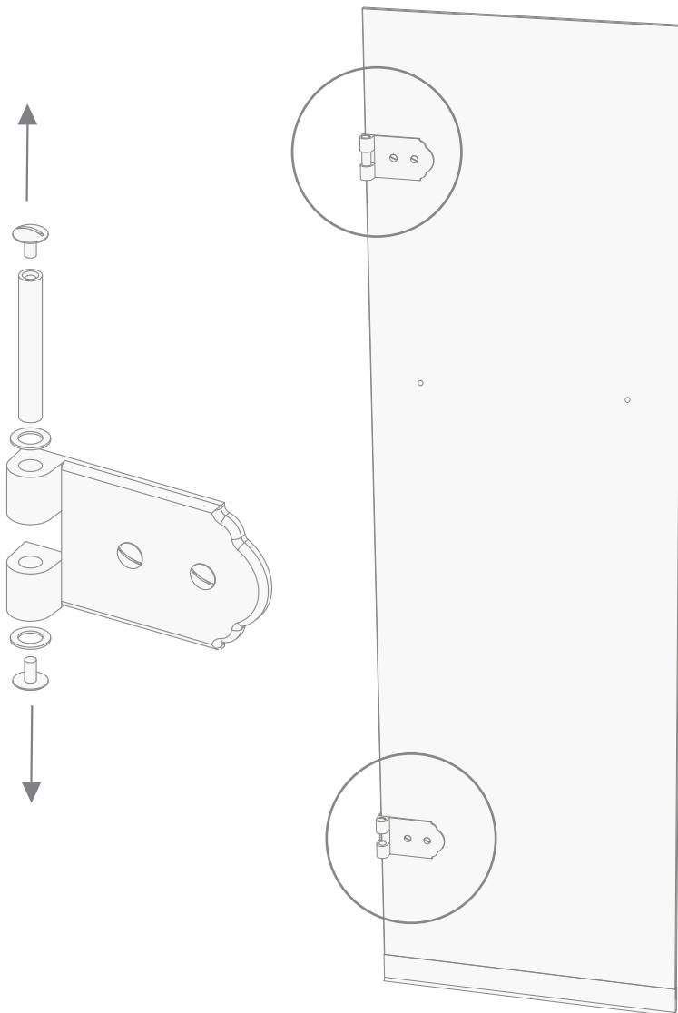
**16)** Seguidamente, coloque la puerta (C) en la estructura anteriormente montada enroscando las espigas previamente desmontadas de ambas bisagras.
