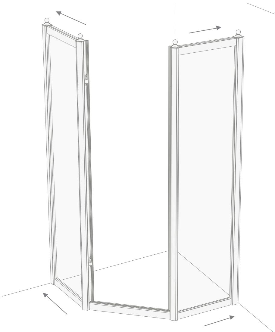
**6)** Отметьте карандашом положение двух предварительно просверленных отверстий, вверху и внизу, с внутренней стороны обоих профилей (A).
