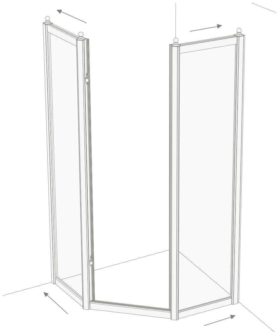
**13)** Posizionare le viti (G), pre-forare, con una punta a ferro ( $\varnothing$  2,5 mm) il montante del lato fisso della porta doccia (quello comprensivo di cerniere).
