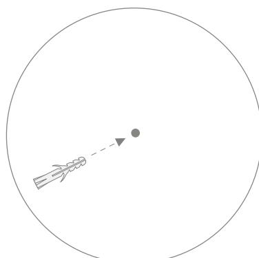
**9)** A ce point, il est possible de fixer à la paroi les deux profils compensateurs des deux côtés fixes. Il est conseillé d'appliquer un fil de silicone sur les parois, à hauteur des profils, de manière à bien les bloquer.
