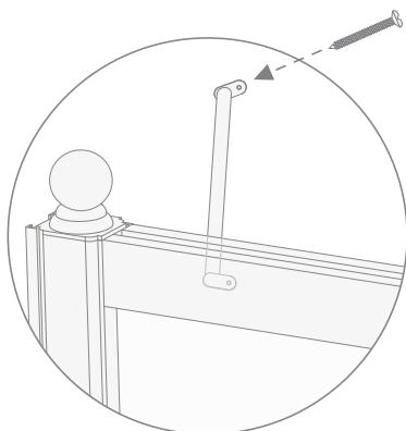
**25)** Fixer la tige avec la rondelle (H), la vis (G) et le bouchon (I) au montant.
