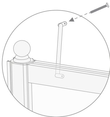
**25)** Die Stange mit der Unterlegscheibe (H), der Schraube (G) und dem Stopfen (I) an der Säule befestigen.
