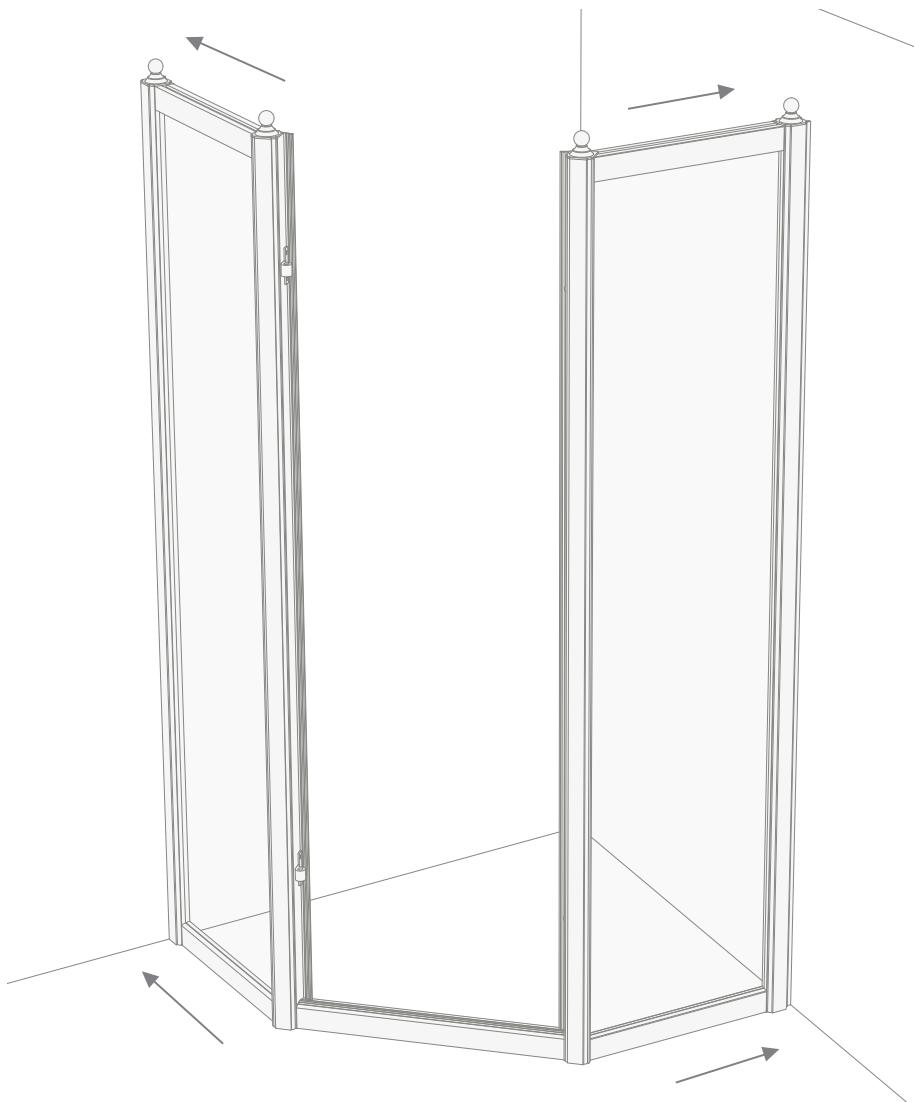
**6)** A l'aide d'un crayon marquer les deux points pré-percés, en haut et en bas, à l'intérieur des deux profilés (A).
