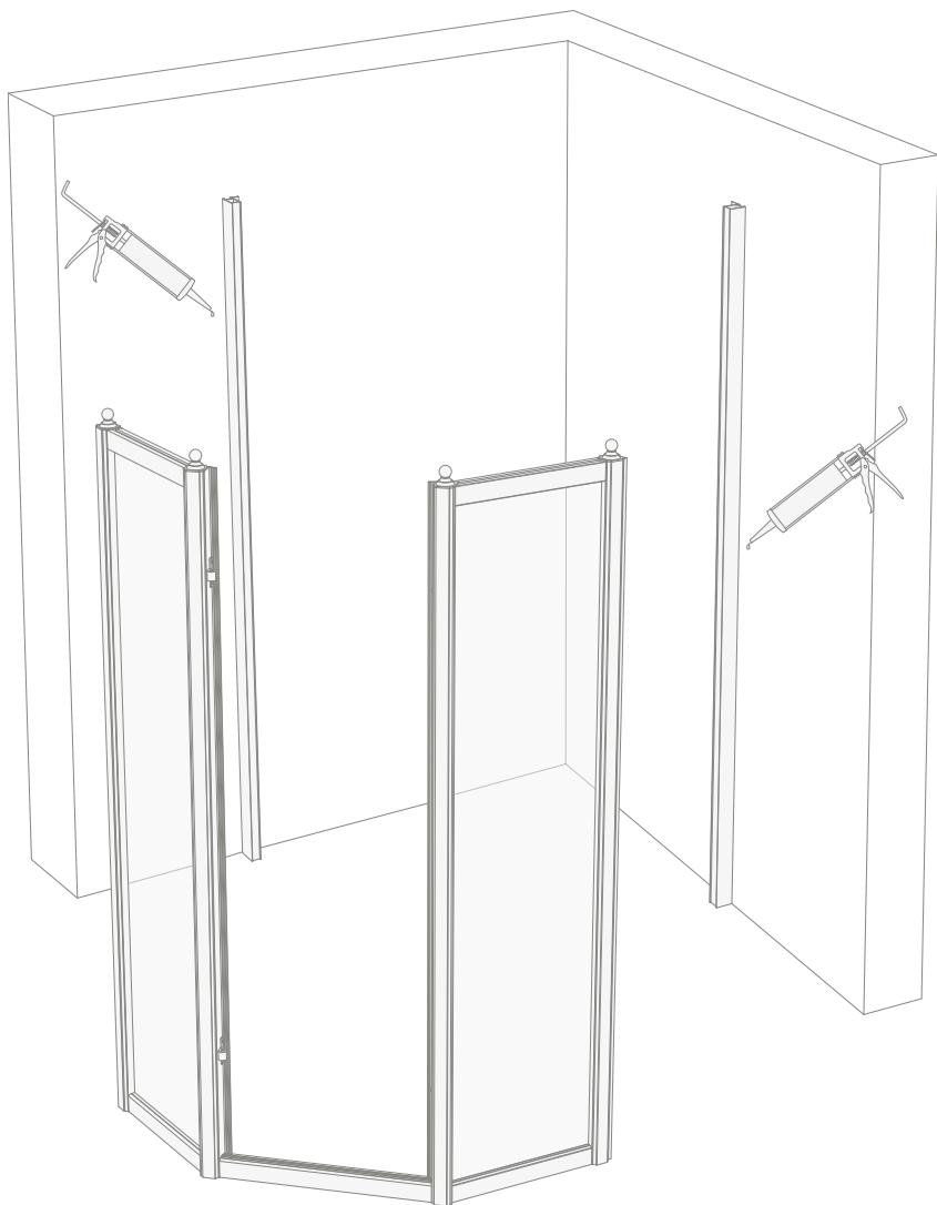
**10)** Укрепите на стене дверь душа при помощи вложенных в комплект стальных шурупов (E) до полного крепления их к стенам.
