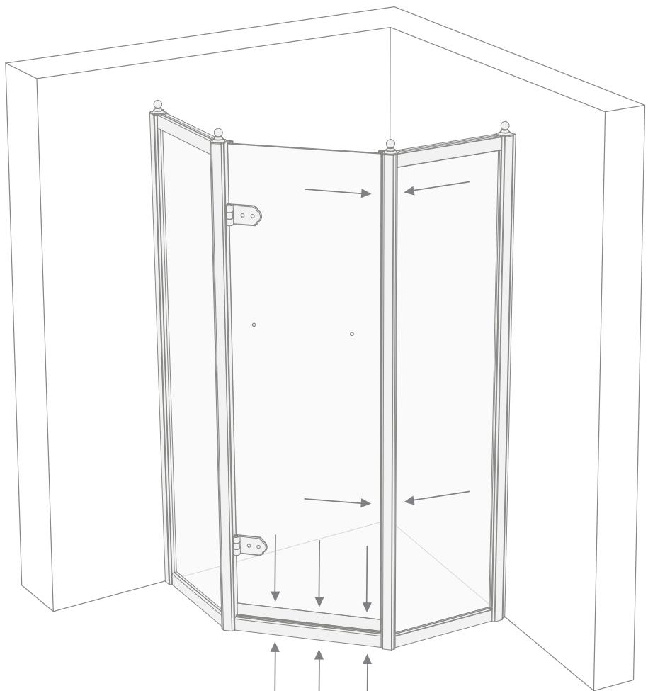
**18)** После регулировки двери можно установить шурупы (G) и засверлить сверлом по металлу ( $\varnothing$  2,5 мм) отверстия в другой неподвижной части двери душа.
