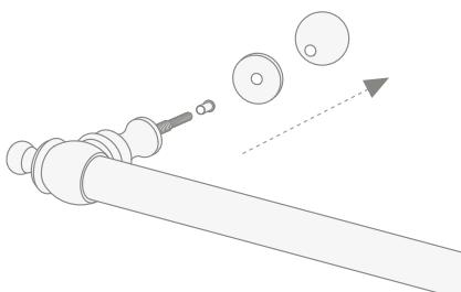
**29)** Den Griff (M) in die vorhandenen Bohrungen an der Scheibe der Duschtür einsetzen.
