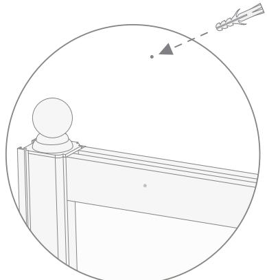
**24)** Fissare l'asta con la vite nel punto A sul muro.
