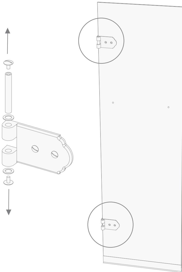
**16)** После этого можно установить дверь(С) на ранее собранную структуру снова ввернув ранее снятые оси обеих петель.
