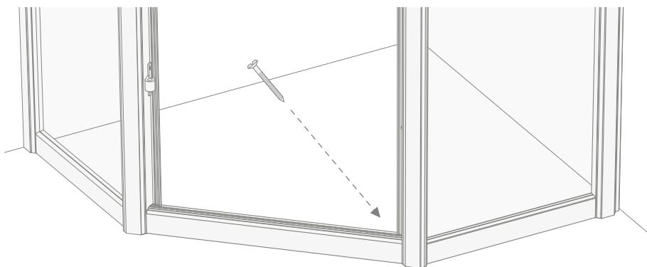
**5)** A este punto, se pueden colocar en la pared los lados fijos con zócalo. Ponga mucha atención en encontrar el punto mejor de montaje entre la puerta de la ducha, las paredes y el plato de la ducha.
