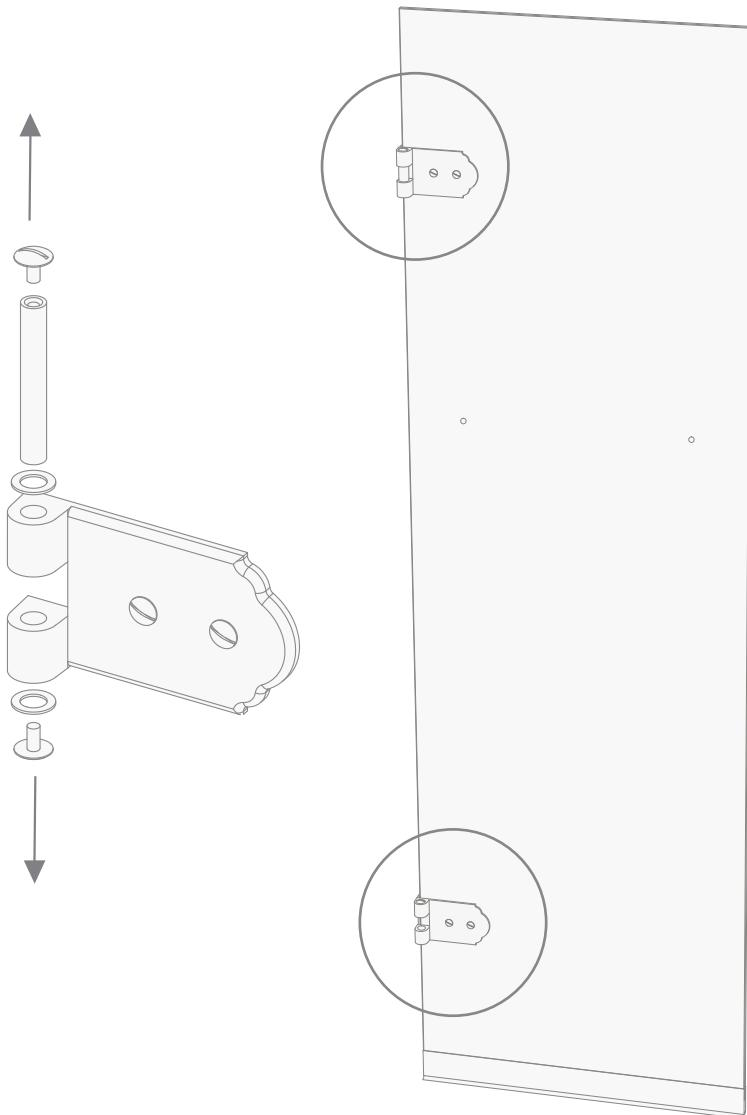
16) Nun die Tür (C) am vorher montierten Aufbau anbringen, dazu die Zapfen von beiden vorher ausgebauten Scharnieren wieder anschrauben.
