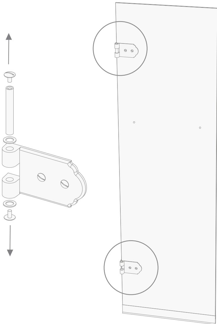
**16)** A questo punto, posizionare la porta (G) sulla struttura precedentemente montata riavvitando i perni di entrambe le cerniere precedentemente smontati.
