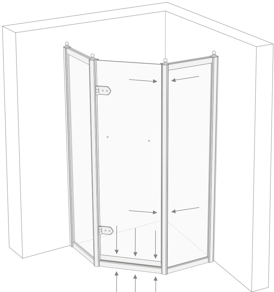
**18)** La porte étant parfaitement réglée, il est maintenant possible de positionner les vis (G) et pré-percer au moyen d'une pointe de fer ( $\varnothing$  2,5 mm) le montant de l'autre côté fixe de la porte de douche.
