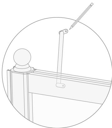
**22)** Просверлите сверлом для стены отверстие в стене (точка А), и сверлом по металлу, отверстие в верхней стойке неподвижной стороны (точка В).
