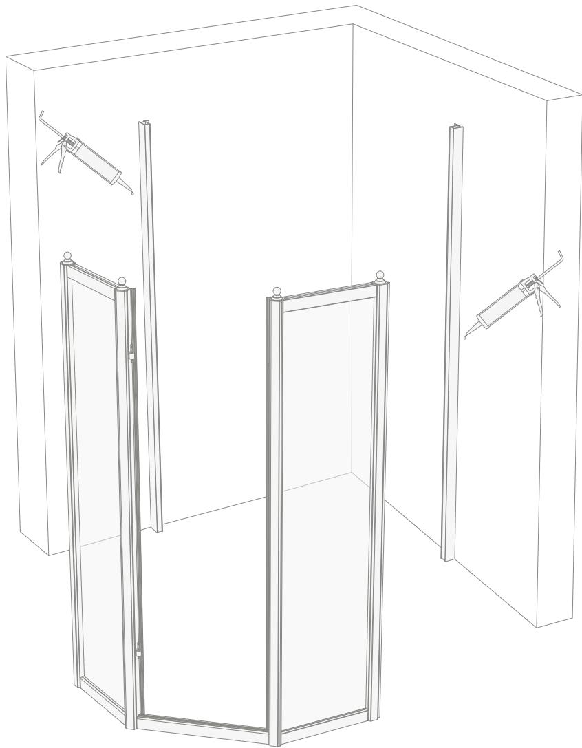
**10)** Fije en la pared la puerta de la ducha utilizando los tornillos de acero proporcionados (E), hasta que quede completamente fijada en las paredes.
