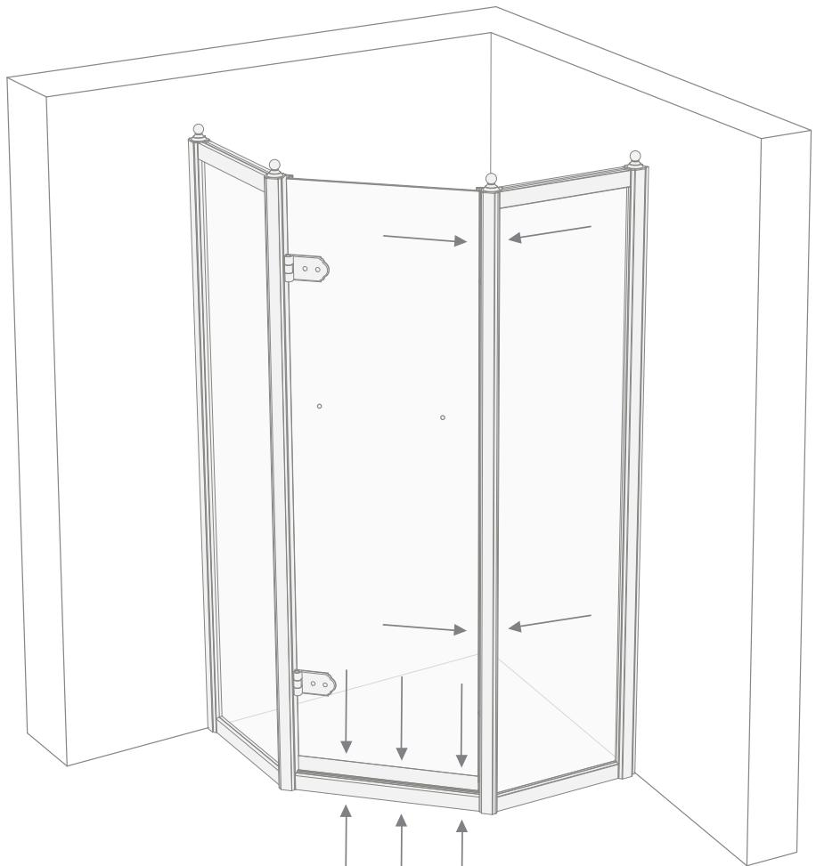
**18)** Con la porta perfettamente regolata adesso è possibile posizionare le viti (F), pre-forare, con una punta a ferro ( $\varnothing$  2,5 mm) il montante dell'altro lato fisso della porta doccia.
