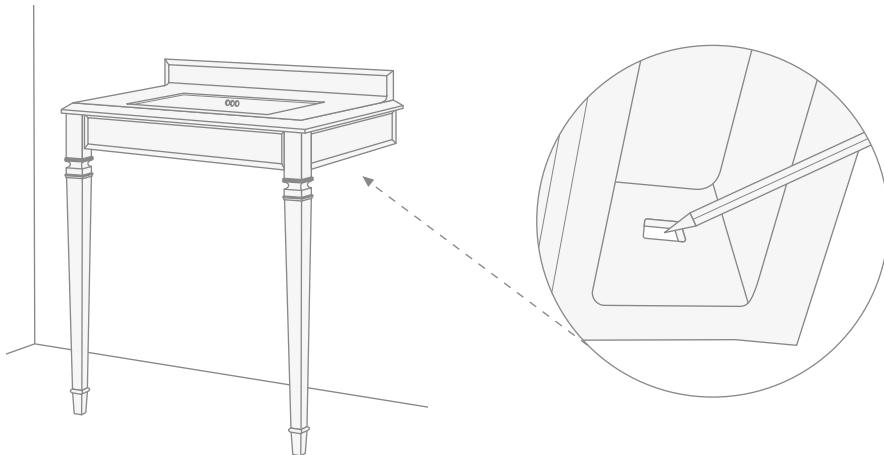
**10)** Rimuovere la struttura dal muro, eseguire le forature, montare i tasselli a muro e avvitare le viti (G).
