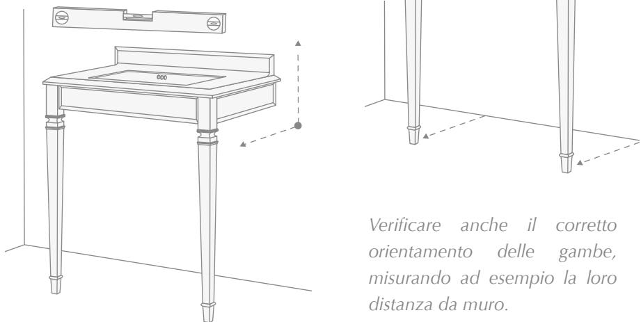
*Verificare anche il corretto orientamento delle gambe, misurando ad esempio la loro distanza da muro.*
