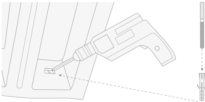
**11)** Снова приставить конструкцию к стене и зафиксировать при помощи винтов с пластмассовыми шайбами (Н).
