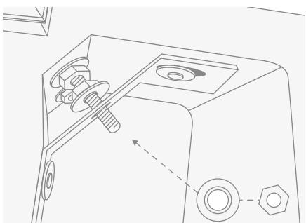
**6)** Завинтить ключом 13 мм три болта на резьбовом штыре, не затягивая их окончательно.
