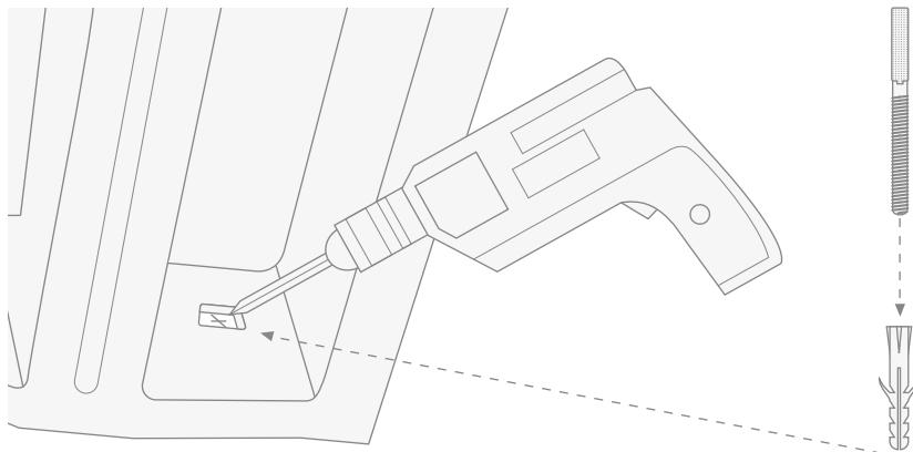
**11)** Vuelva a colocar la estructura apoyándola en la pared y bloqueándola con las arandelas de plástico (H).
