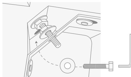
*Die Inbusschraube mit dem geeigneten Schlüssel einschrauben, aber noch nicht festziehen.*
