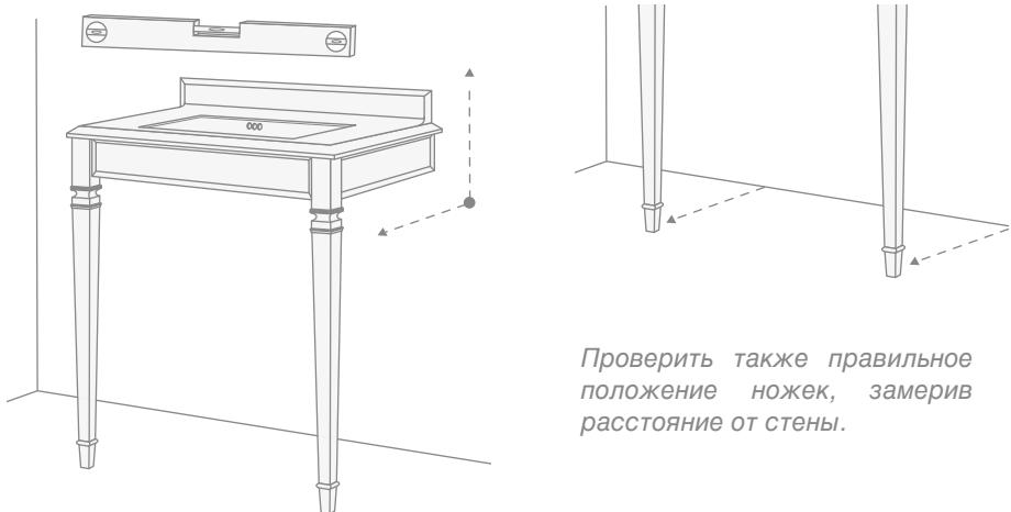
**8)** При необходимости, отрегулировать положение при помощи гаек, навинченных на резьбовой штырь. После регулировки ножек затянуть гайки и шлицевые винты.
