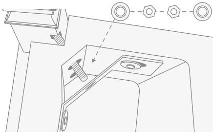
*La barra roscada debe atravesar la ranura de la abrazadera metálica.*
