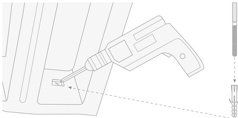
**11)** Posizionare di nuovo la struttura appoggiandola a muro e bloccarla avvitando le viti con le rondelle in plastica (H).
