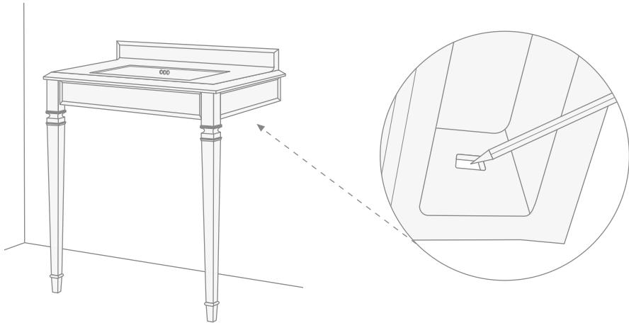
**10)** Retirer la structure du mur, percer, monter les chevilles pour la fixation au mur et visser (G).
