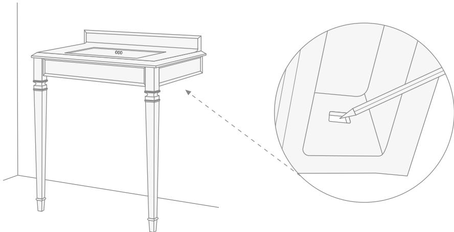
**10)** Aparte de la pared la estructura, haga los agujeros, monte los tacos en la pared y enrosque los tornillos (G).
