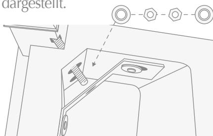
*Die Gewindestange muss durch die im Metallbügel vorhandene Bohrung gehen.*
