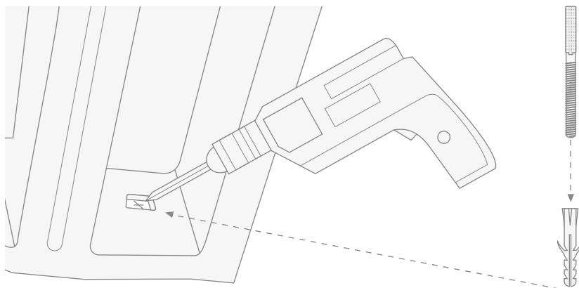
**11)** Placer à nouveau la structure contre le mur, puis la bloquer en vissant les vis avec les rondelles en plastique (H).
