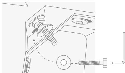
Ввинтить шлицевый винт инбусовым ключом, не затягивая его окончательно.
