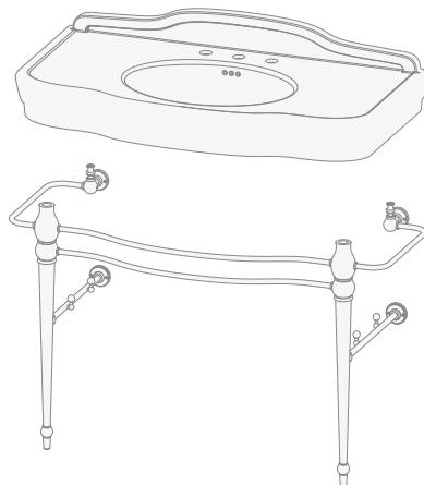
**13)** Dopo aver verificato la corretta posizione del lavabo, segnare i quattro fori di fissaggio (indicati nell'immagine sottostante del retro).
