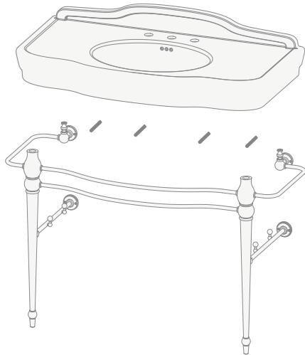
**17)** Bloquee el lavabo de cerámica utilizando las arandelas de plástico (I) proporcionadas.
