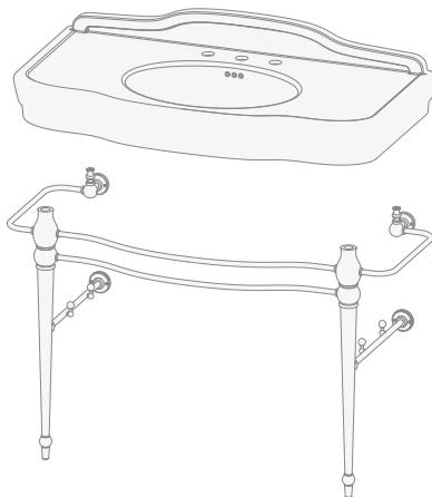
13) После проверки правильного положения раковины, отметьте положение четырех крепежных отверстий (показанных на нижеприведенном рисунке задней стороны).
