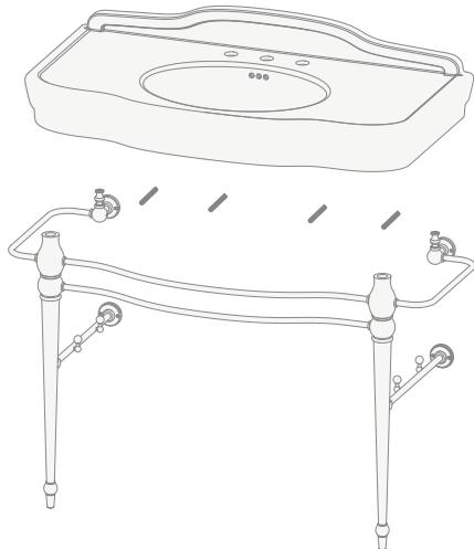
**17)** Bloccare il lavabo in ceramica con le rondelle di plastica (I) in dotazione.
