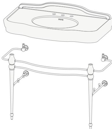
**13)** Après avoir vérifié la position correcte du lavabo, marquer les quatre points de fixation (indiqués dans l'image située sur la partie arrière).
