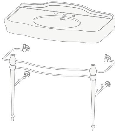
**13)** Nach der Überprüfung der korrekten Position des Waschbeckens, markieren Sie die vier Befestigungslöcher (wie in der Abbildung dargestellt).
