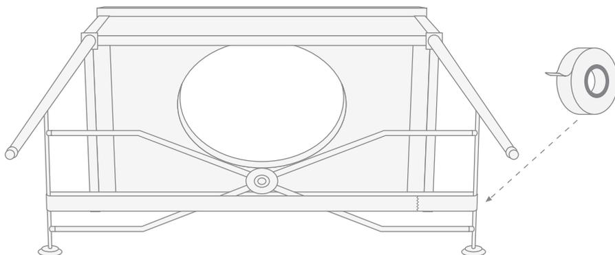
7) Presentare a muro la struttura così assemblata. Verificare il posizionamento della struttura tramite una livella in direzione sia parallela che ortogonale a muro.
