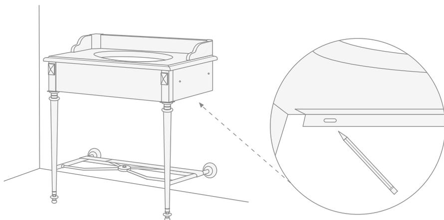
**10)** Aparte de la pared la estructura ensamblada y haga los agujeros en las marcas.
