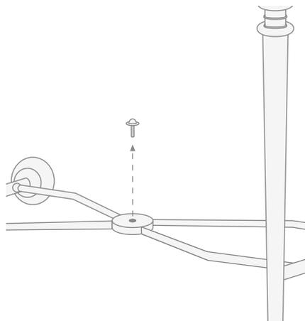
**18)** Die Glasablage (C) positionieren und mit der mittleren Schraube befestigen.
