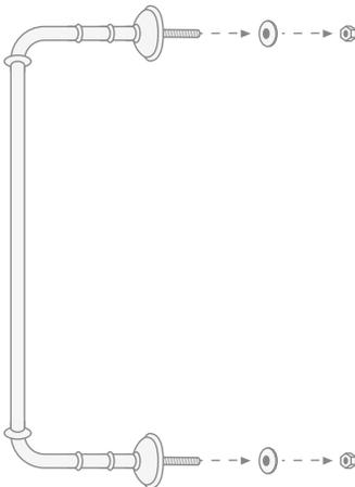
**12)** Den Handtuchhalter in seine Aufnahme einsetzen und durch Einschrauben der Bolzen mit den Unterlegscheiben an der Innenseite der Marmorabdeckplatte befestigen.
