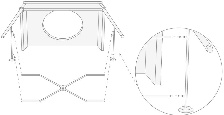
6) Das Kreuzstück vorläufig mit einem Klebeband an den Beinen befestigen (dazu kann der Bereich der Verbindungsstücke geschützt werden, der mit dem Klebeband in Berührung kommt).
