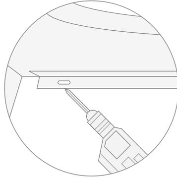
*Positionnez à nouveau la structure au mur, fixez-la à l'aide des vis sur les petits bras des pattes et fixez l'étrier de support.*
