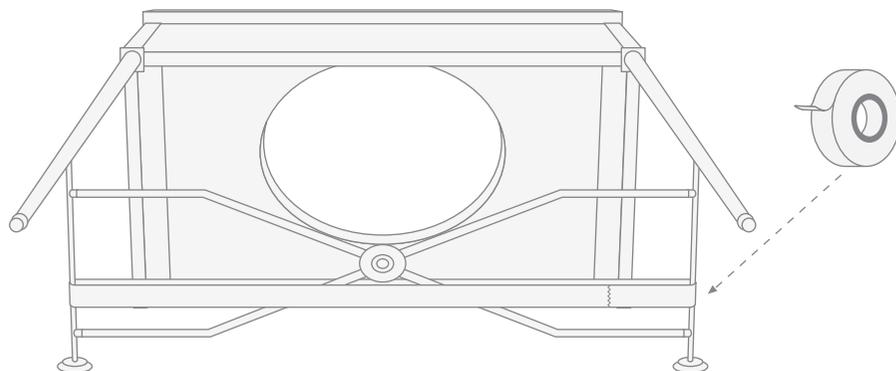
7) Приставить собранную таким образом конструкцию к стене. Проверить уровнем параллельное и ортогональное положение самой конструкции по отношению к стене.
