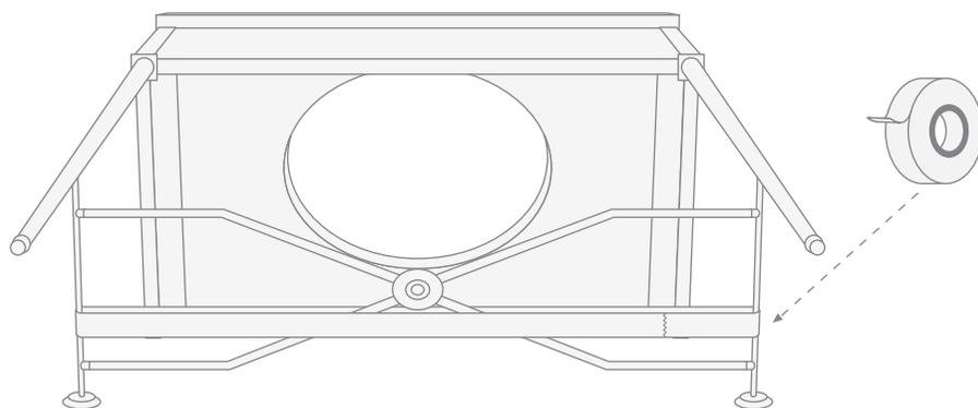
7) Adossez au mur la structure assemblée. Vérifiez le positionnement de la structure à l'aide d'un niveau en direction parallèle et perpendiculaire au mur.
