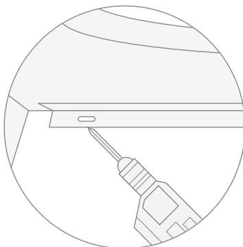
*Снова приставить конструкцию к стене, прикрепить ее винтами на рычажках ножек и зафиксировать опорный кронштейн.*
