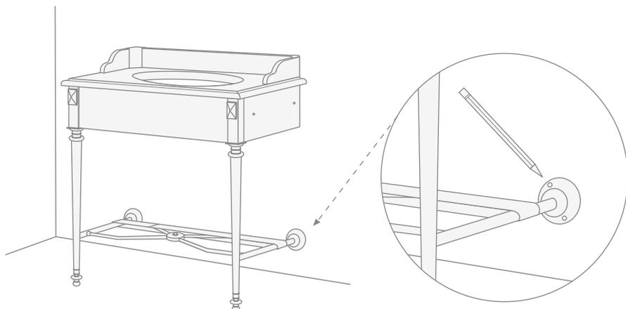
**9)** Tracciare i fori di fissaggio della staffa (B) di supporto a muro. La staffa ha una sezione a forma di "L" e deve essere posizionata sotto alla faccia posteriore del top che è a contatto con il muro.
