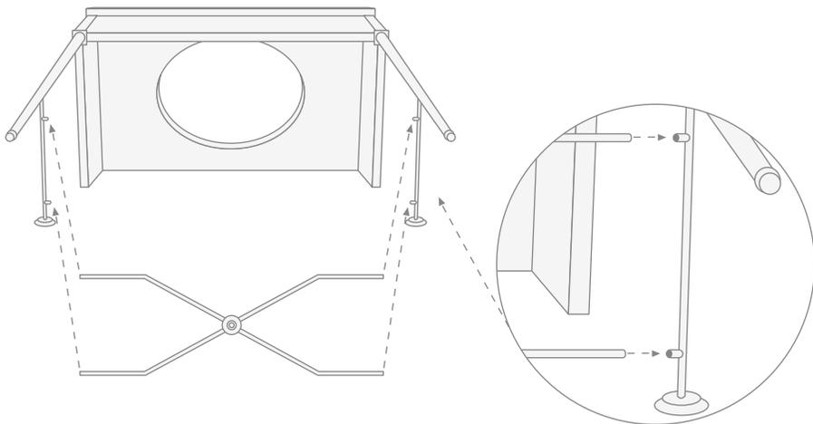
6) Sujete momentáneamente la cruz a las patas utilizando la cinta adhesiva (protegiendo la parte de los brazos en contacto con la cinta adhesiva).
