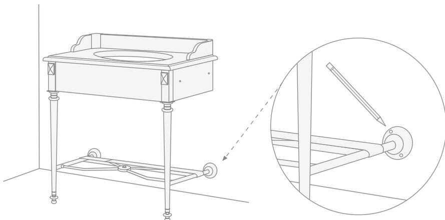
**9)** Tracez les trous de fixation de l'étrier (B) de support mural. L'étrier a une section en forme de «L» et il doit être placé sous la face arrière du dessus en marbre qui est en contact avec le mur.
