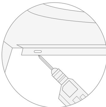
*Riposizionare la struttura a muro, fissarla con le viti sui braccetti delle gambe e fissare la staffa di supporto.*
