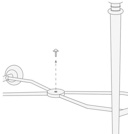
**18)** Coloque la repisa de cristal (C) y bloquéela con el tornillo central.
