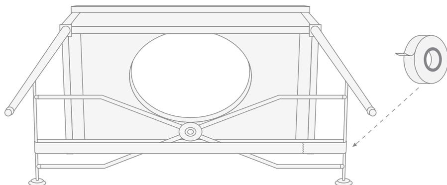
7) Apoye la estructura en la pared la estructura tal y como está ensamblada. Compruebe la posición de la estructura utilizando un nivel en dirección paralela y ortogonal respecto a la pared.
