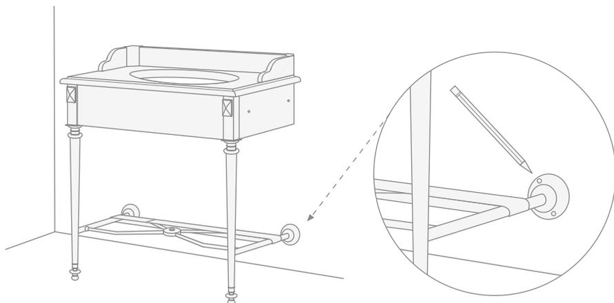
**9)** Marque en la pared los agujeros de fijación de la platina de soporte (B). La platina tiene forma de "L" y debe ser colocada por debajo de la parte trasera de la encimera que está en contacto con la pared.
