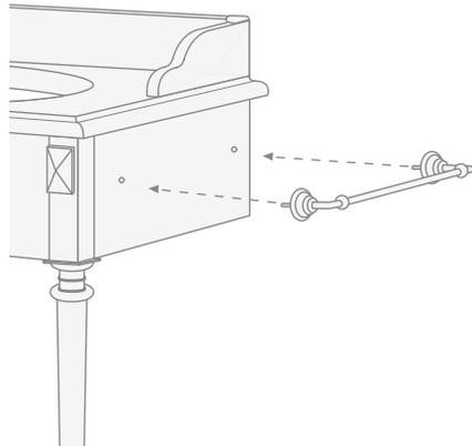
**13)** Die Dekore (F) durch Befestigung mit den Pinakeln (I) montieren.
