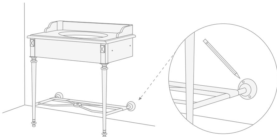
**9)** Отметить на стене места под крепления опорного кронштейна (В) к стене. Кронштейн имеет L-образное сечение и должен располагаться под задней стенкой верха, контактирующей со стеной.
