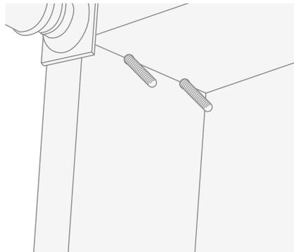
**4)** Vuelva a introducir las platinas internas en las barras roscadas. Después, coloque los espesores y las barras roscadas. Enrosque los tornillos, bloqueando rígidamente la pata.
