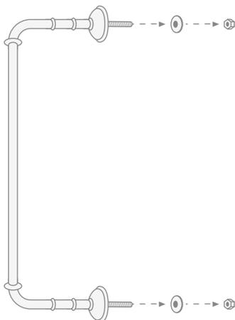
**12)** Inserire il portasciugamani nella sua sede e fissarlo avvitando i bulloni con le relative rondelle dalla parte interna del top in marmo.
