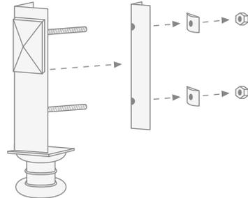
*Die Muttern losschrauben und die Zwischenstücke sowie die inneren Platten von den Gewindestangen im Oberteil des Beins entfernen.*
