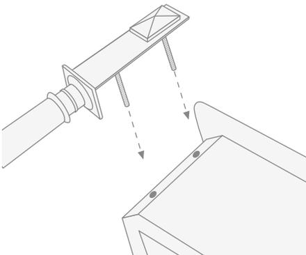
**3)** Ponga la pata en contacto con la encimera de mármol, comprobando que ambas barras roscadas sobresalgan por la parte interna de la encimera.
