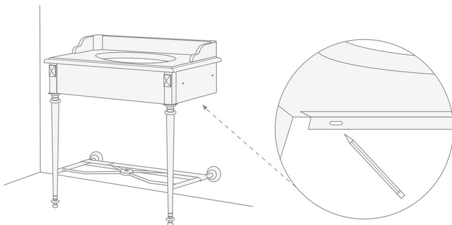
**10)** Rimuovere da muro la struttura assemblata ed eseguire tutte le forature secondo le tracciatore.
