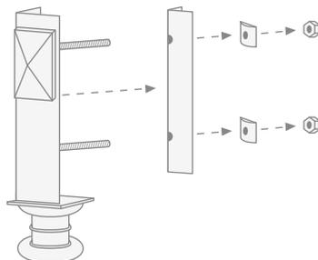
*Dévissez les écrous et enlevez les épaisseurs et les plaques internes insérées sur les barres filetées dans la partie supérieure de la patte.*
