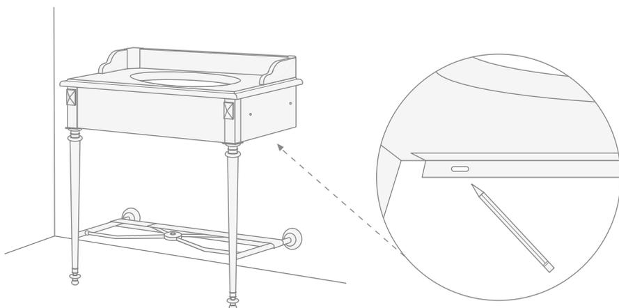
**10)** Retirez du mur la structure assemblée et réalisez tous les trous selon les traçages.
