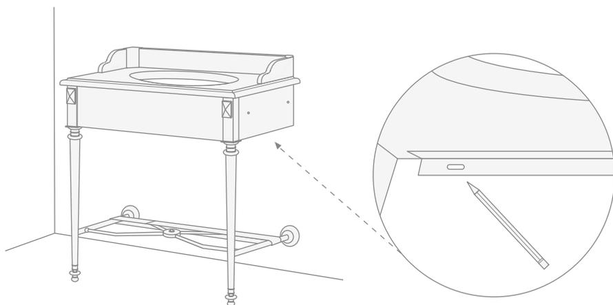
**10)** Die zusammengebaute Trägerkonstruktion von der Wand entfernen und alle Bohrungen an den markierten Stellen ausführen.
