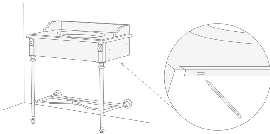
**10)** Отнять от стены собранную конструкцию и просверлить отверстия в намеченных местах.
