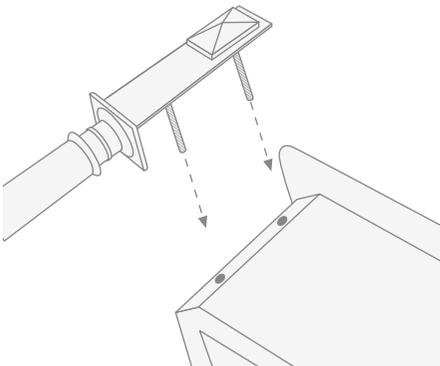
**3)** Das Bein in Berührung mit der Marmorabdeckplatte bringen und prüfen, ob beide Gewindestangen aus dem inneren Teil der Abdeckplatte hervorstehen.
