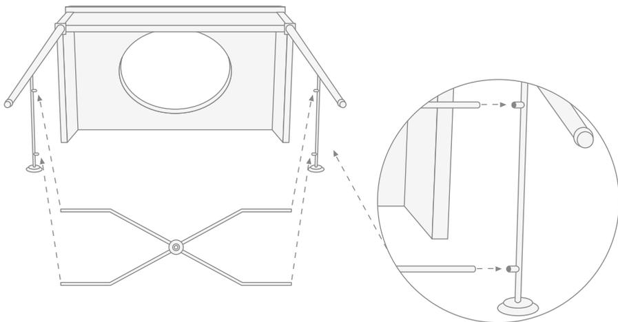
6) Зафиксировать временно крестовину на ножках при помощи клейкой ленты (попытайтесь защитить рычажки от непосредственного контакта с клейкой лентой).
