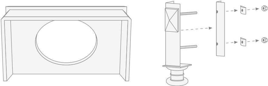
*Destornille las tuercas y quite los espesores y las platinas internas introducidas en las barras roscadas situadas en la parte superior de la pata.*
