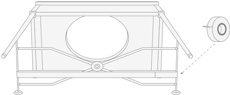
7) Die so zusammengebaute Trägerkonstruktion an die Wand stellen. Die Lage der Trägerkonstruktion mit einer Wasserwaage parallel und senkrecht zur Wand prüfen.
