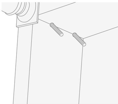
4) Снова насадить внутренние шайбы на резьбовые штыри. Затем насадить уплотнения и гайки на резьбовые штыри. Наконец, завинтить и затянуть болты, быстро блокируя таким образом ножку.
