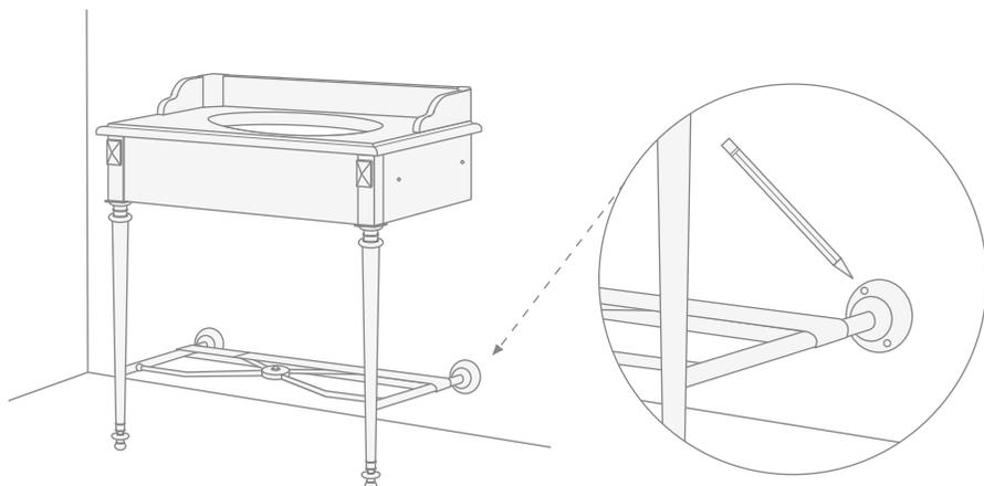
**9)** Die Befestigungslöcher für den Wandbefestigungsbügel (B) anzeichnen. Der L-förmige Bügel muss unterhalb der Rückseite der Abdeckplatte angebracht werden, die die Wand berührt.
