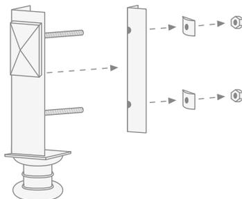
*Выверните гайки и удалите уплотнения и внутренние шайбы с резьбовых штырей в верхней части ножки.*
