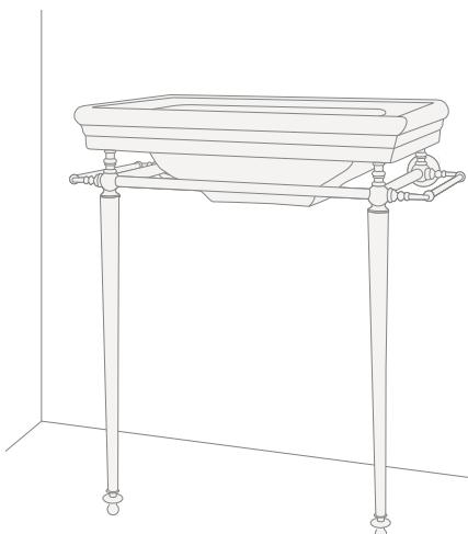
**15)** Placer la tablette en verre sur les appuis des pattes et, à l'aide d'un niveau, tracer des marques pour réaliser dans le mur les trous pour les supports (J).
