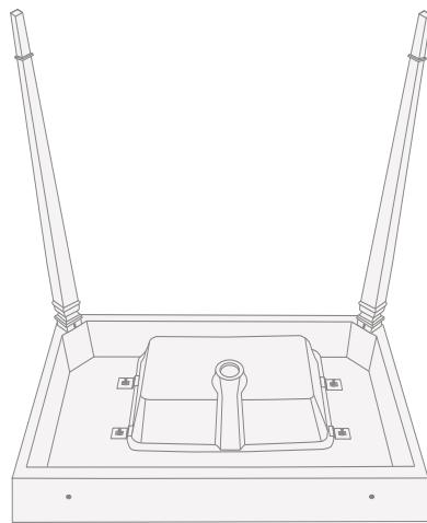
**10)** Retourner la structure et la placer contre le mur afin de vérifier sa position à l'aide d'un niveau (parallèlement et perpendiculairement par rapport au mur).
