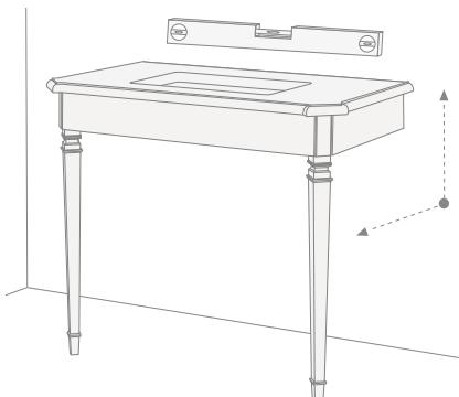
**11)** Une fois obtenue la meilleure position possible, tracer les marques des 2 trous pour la fixation de la console au mur. Il est alors possible de retirer la console, de faire les trous dans le mur et d'introduire dans ces derniers des chevilles non fournies. Placer de nouveau la console contre le mur et fixer celleci avec des vis non fournies.
