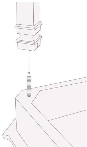
**5)** Зафиксировать ножки с помощью имеющихся в них установочных винтов и торцевого шестигранного люча (C).
