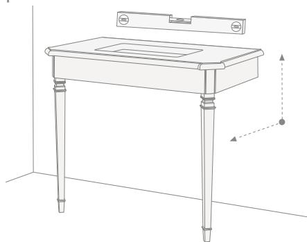
**11)** Una vez alcanzada la mejor colocación posible, marcar los 2 agujeros para la fijación de la consola a la pared. Ahora es posible quitar la consola, realizar los agujeros en la pared e introducir los tacos (no incluidos en el kit). Colocar de nuevo la consola en la pared y fijarla con tornillos (tampoco incluidos en el kit).
