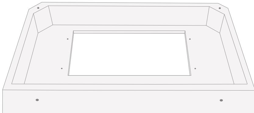
**2)** Ввинтить стержни с резьбой в 2 отверстия в углах передней части мраморной столешницы.
