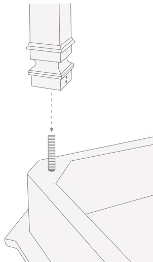
**5)** Fixieren Sie die Beine mit den schon an den Beinen befestigten Stiften und dem Inbusschlüssel (C).
