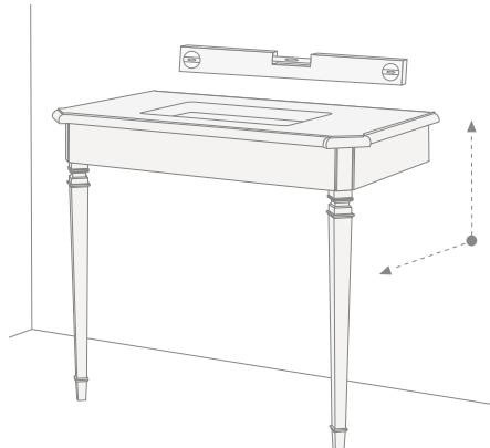
**11)** Una volta raggiunto il miglior posizionamento possibile, tracciare i 2 fori per il fissaggio della consolle a muro. Adesso è possibile rimuovere la consolle, eseguire le forature a muro e inserire i tasselli non forniti. Posizionare di nuovo la consolle al muro e fissarla con viti anch'esse non fornite.
