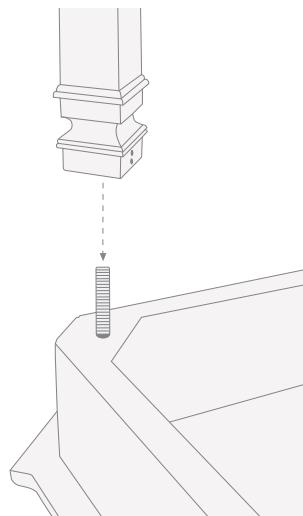
**5)** Bloquer les pattes avec les têtes de boulon déjà insérées dans les pattes et la clé Allen (C).
