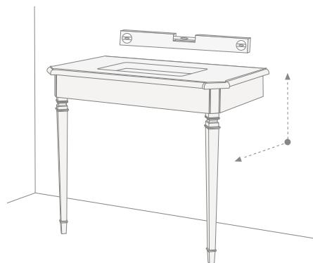
**11)** После достижения максимальной ровности наметить 2 точки под крепежные отверстия в стене. Теперь можно отодвинуть консоль, просверлить в стене отверстия и вставить дюбели (в комплект не входят). Снова приставить консоль к стене и акрепить винтами (в комплект не входят).
