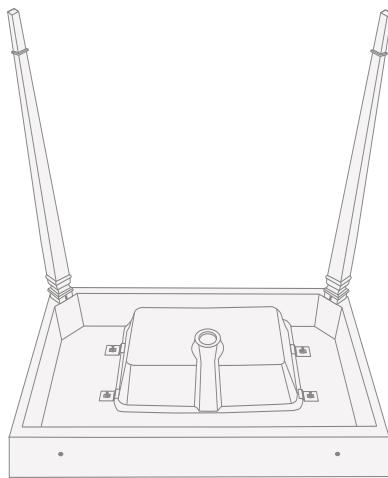
**10)** Dar la vuelta a la estructura y apoyarla en la pared, comprobando la colocación de la estructura con un nivel en dirección paralela y perpendicular respecto a la pared.
