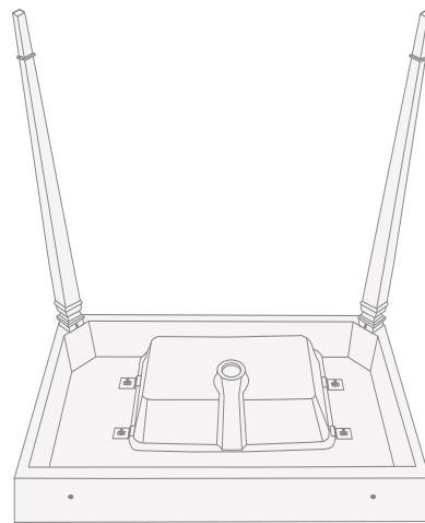
**10)** Drehen Sie das Gestell um, lehnen Sie es an die Wand und überprüfen Sie mit Hilfe einer Wasserwaage die Position sowohl in orthogonaler wie in paralleler Richtung zur Wand.
