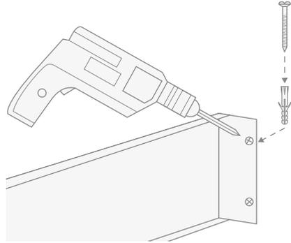
*Vuelva a colocar la estructura apoyándola en la pared y bloquéela con los tornillos proporcionados.*
