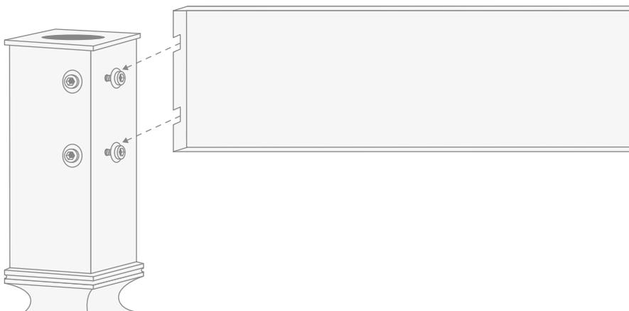
**7)** Затяните винты соответствующим торцевым шестигранным ключом.
