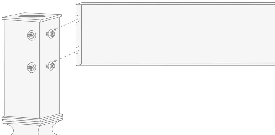
**7)** Nun die Inbusschrauben mit dem entsprechenden Schlüssel festziehen.
