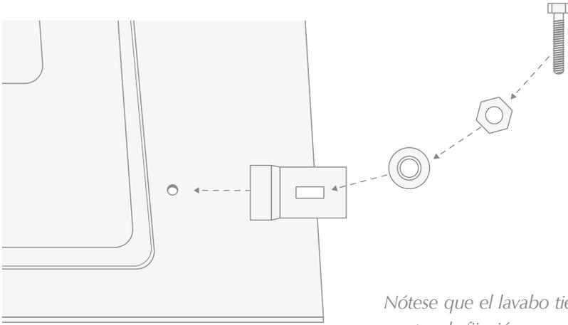
*Nótese que el lavabo tiene 4 puntos de fijación.*
