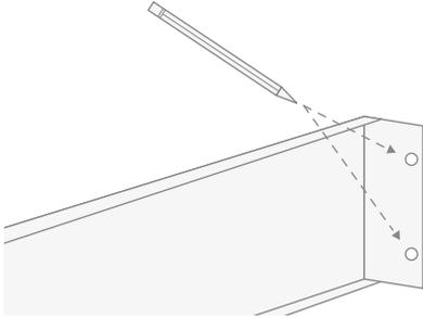
**11)** Enlever la structure du mur, réaliser les trous et introduire les chevilles dans le mur.
