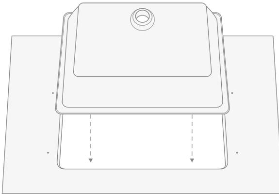
**15)** Fije el lavabo a la encimera utilizando las platinas (K), los tornillos (L), las tuercas (M) y las arandelas (N).
