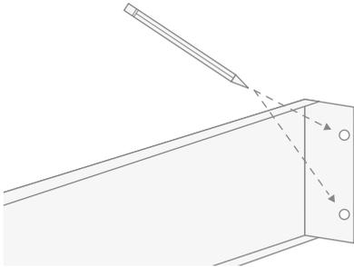
**11)** Die Struktur von der Wand entfernen, die Bohrungen vornehmen und die Dübel einführen.
