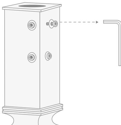
Si l'une des vis à six pans a été dévissée excessivement et si vous avez du mal à la revisser, il est possible de démonter le couvercle au sommet de la patte au moyen d'une clé à douille de 17 mm. Cela vous permet de tenir la plaque métallique taraudée à l'intérieur de la patte et de visser à nouveau la vis à six pans.
