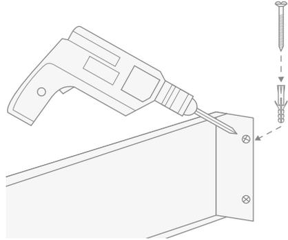
*Positionner à nouveau la structure en l'adossant au mur et la bloquer au moyen des vis fournies.*
