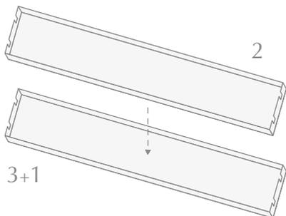
*Repita el mismo ensamblaje a la hora de montar las barras planas laterales.*
