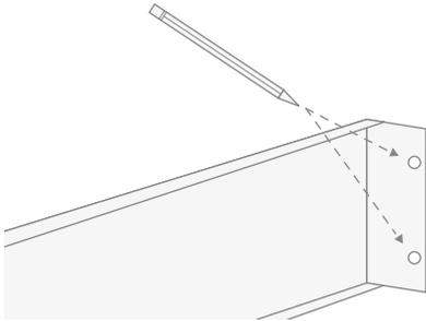
**11)** Отставьте в сторону конструкцию, просверлите отверстия, вставьте дюбели в стену.
