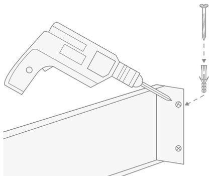
*Posizionare di nuovo la struttura appoggiandola a muro e bloccarla con le viti in dotazione.*
