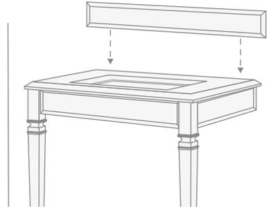
*Darauf achten, dass der rückwärtige Wandabschluss exakt positioniert ist, bevor das Silikon trocken ist.*
