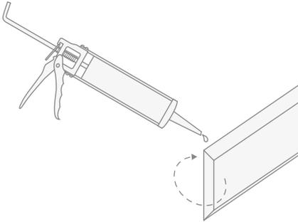
**19)** Posizionare l'alzatina centrandola rispetto al top e poi appoggiarla correttamente a muro.
