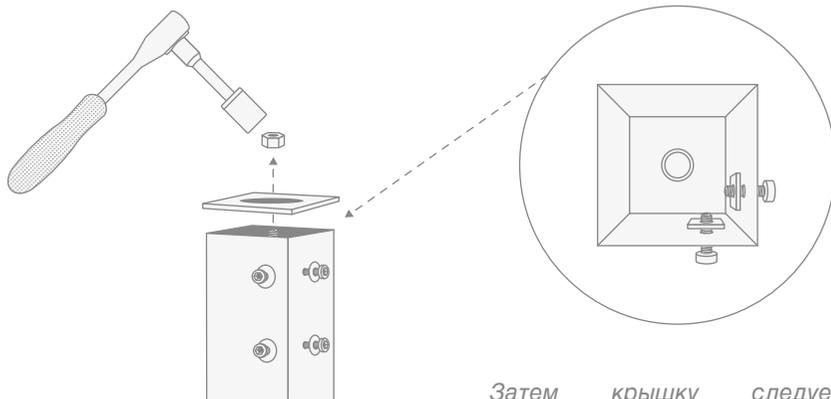
Затем крышку следует установить на место.
