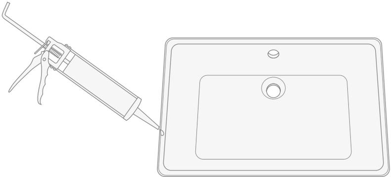
**14)** Coloque el lavabo sobre la superficie no pulida de la encimera de mármol y compruebe que la colocación sea correcta, antes de que se seque la silicona.
