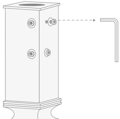
Qualora sia stata svitata eccessivamente una delle viti a brugola ed abbiate difficoltà poi nel riavvitarla, è possibile smontare il coperchio alla sommità della gamba con una chiave a tubo di 17 mm. In questo modo potete tenere ferma la piastra metallica filettata all'interno della gamba e avvitare di nuovo la vite a brugola.
