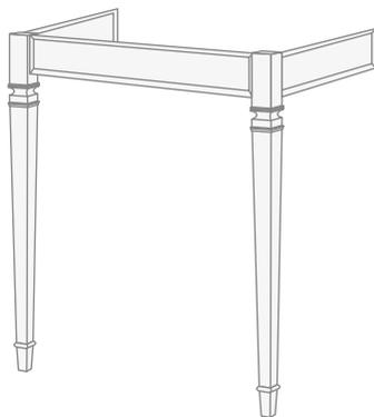
Adosser au mur la structure ainsi assemblée, en vérifiant le positionnement à l'aide d'un niveau parallèlement et perpendiculairement au mur.
