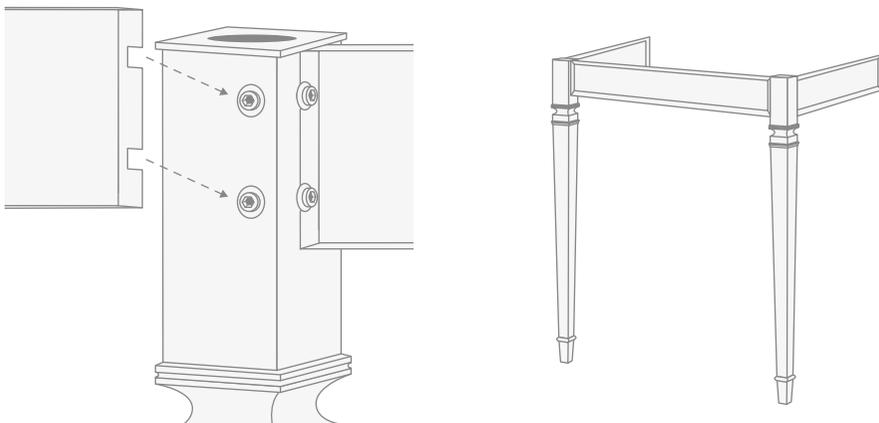
Apoye en el muro la estructura tal y como la ha ensamblado, comprobando la posición con un nivel en dirección paralela y ortogonal respecto a la pared.
