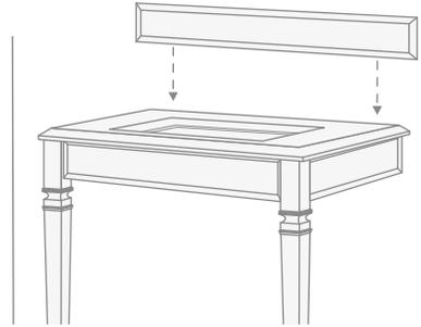
*Vérifier que l'exactitude de la position de la rehausse avant que la silicone ne sèche.*
