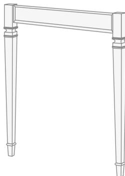
9) Тем же способом прикрепите боковые пояса. Следует учесть, что на боковых поясах U-образные вырезы имеются только на одном конце. На другом их конце расположены два отверстия для крепления к стене.
