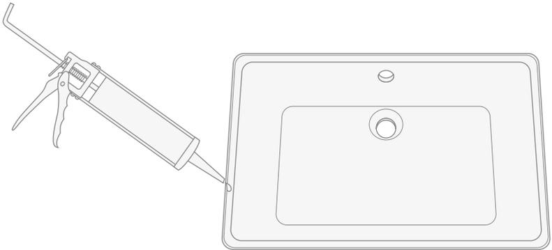
**14)** Das Waschbecken auf die nicht polierte Seite der Marmorablage positionieren und die korrekte Ausrichtung prüfen, bevor das Silikon trocknen kann.
