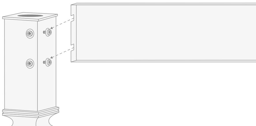
**7)** Serrer les vis à six pans au moyen d'une clé appropriée.
