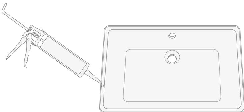
**14)** Posizionare il lavabo sulla superficie non lucidata del top in marmo e verificare che il posizionamento sia corretto, prima che il silicone si asciughi.
