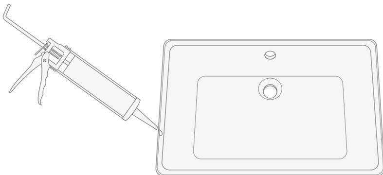
**14)** Установите раковину на неполированную поверхность мраморной столешницы, проверьте правильность её положения до высыхания герметика.
