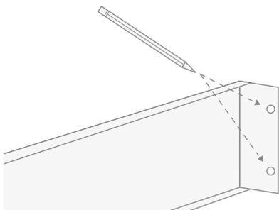
**11)** Rimuovere la struttura dal muro, eseguire le forature e inserire i tasselli a muro.
