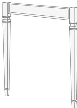
9) Genauso auch die Seitenleisten montieren. An diesen Leisten befindet sich eine einzige U-förmige Öffnung. Die andere Extremität weist hingegen zwei Bohrungen auf, die dazu dienen, die Struktur an die Wand zu befestigen.
