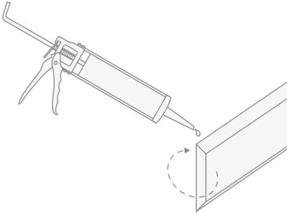
**19)** Den rückwärtigen Wandabschluss so positionieren, dass er gegenüber der Marmorablage zentriert ist und ihn dann korrekt an die Wand fixieren.
