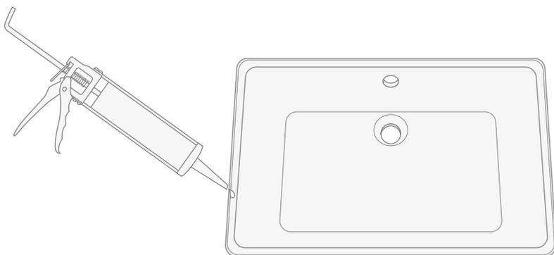
**14)** Positionner le lavabo sur la surface non polie du dessus en marbre et vérifier que la position est correcte avant que la silicone ne s'essuie.
