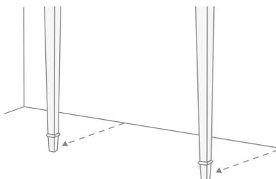
*Vérifier également l'orientation correcte des pattes, en mesurant par exemple leur distance du mur.*
