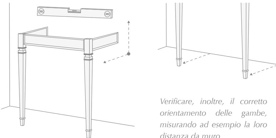
*Verificare, inoltre, il corretto orientamento delle gambe, misurando ad esempio la loro distanza da muro.*
