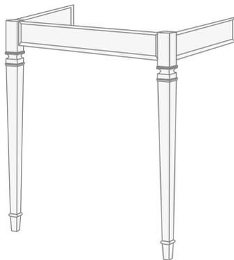
Приставьте собранную конструкцию к стене. Проверьте с помощью уровня горизонтальность и перпендикулярность её положения относительно стены.
