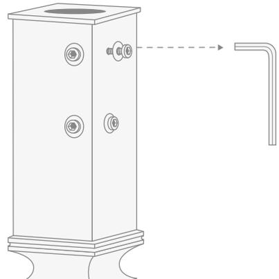
Sollte sich eine der Inbusschrauben zu sehr gelockert haben und sollte es schwierig werden, sie wieder festzuziehen, ist es möglich, die Abdeckung an der Spitze des Beines mit einem Steckschlüssel 17 mm zu entfernen. Auf diese Weise können Sie die Gewindeplatte im Inneren des Beins festhalten und so die Inbusschraube festziehen.
