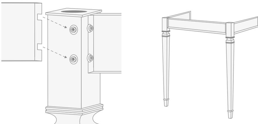
Presentare a muro la struttura così assemblata, verificando il posizionamento con una livella in direzione parallela ed ortogonale al muro.
