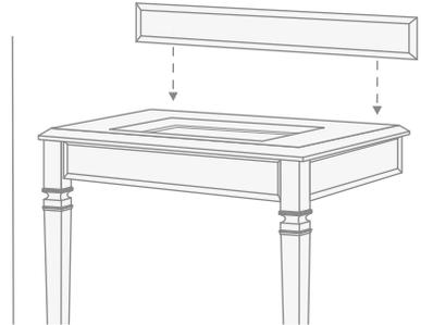
*Verificare che la posizione dell'alzatina sia esatta prima dell'asciugatura del silicone.*
