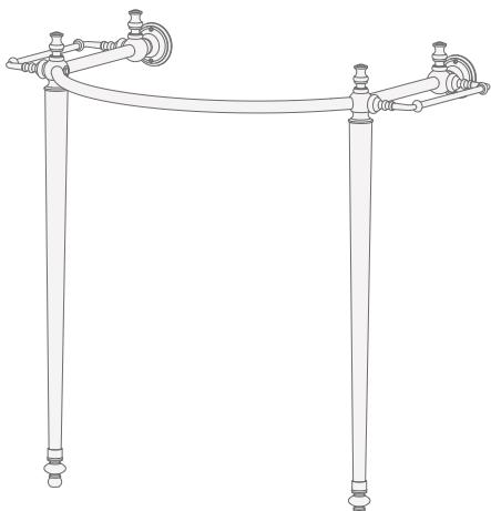
**8)** Posizionare la struttura a muro e verificare il posizionamento con una livella in direzione sia parallela che ortogonale a muro.
