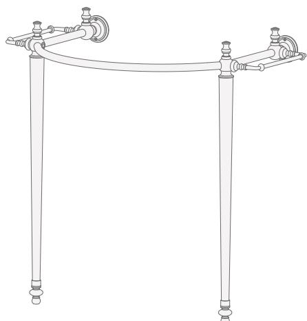
**8)** Приставить конструкцию к стене, уровнем проверить ее параллельность и перпендикулярность к плоскости стены.
