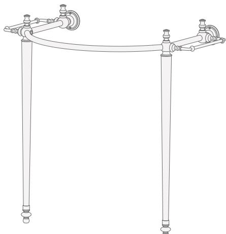
**8)** Lehnern Sie nun das Gestell an die Wand und überprüfen Sie mit Hilfe einer Wasserwaage die Position sowohl in orthogonaler wie paralleler Richtung zur Wand.
