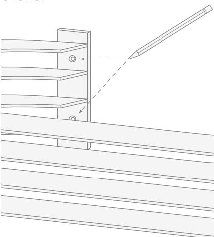
**6)** Отнять конструкцию от стены и просверлить 4 отверстия по отметкам.
