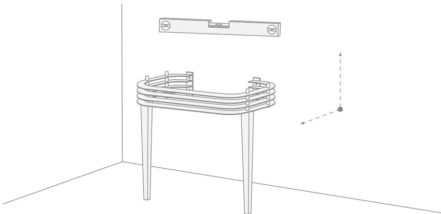
**5)** Tracciare i 4 fori di fissaggio della struttura a muro.
