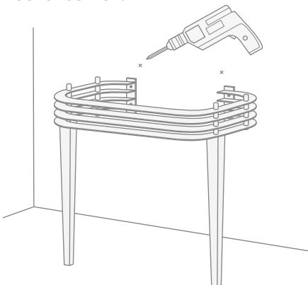
**12)** Die mitgelieferten Dübel in die Löcher einführen, das Waschbecken wieder einsetzen und mit den mitgelieferten Schrauben befestigen.
