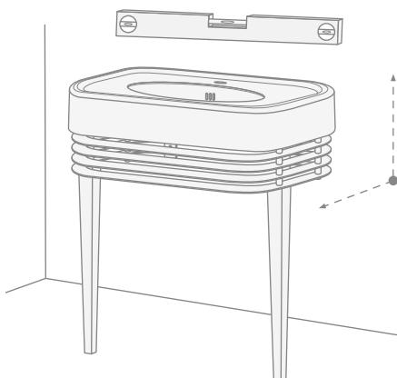
**11)** Tracciare i 2 fori di fissaggio a muro del lavabo. Rimuovere il lavabo ed eseguire i 2 fori in base alla tracciatura.
