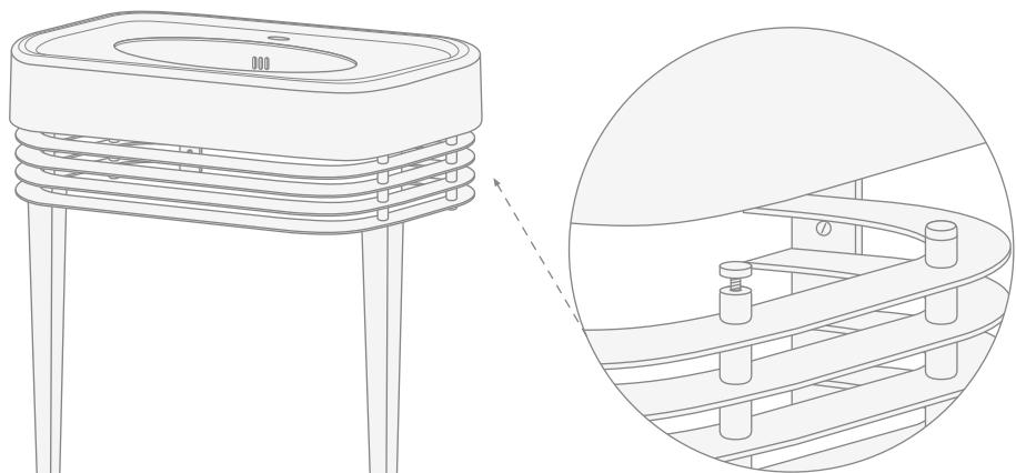
**10)** Verificare il posizionamento definitivo del lavabo tramite una livella.
