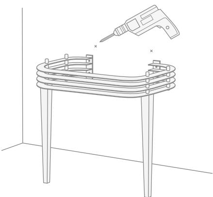
**12)** Вставить дюбели в отверстия, снова установить раковину и зафиксировать ее соответствующими винтами.
