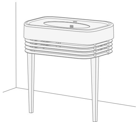
**9)** Il lavabo appoggia sulla struttura in 4 punti: se necessario agire sui supporti regolabili presenti in questi 4 punti per ottenere un risultato migliore.
