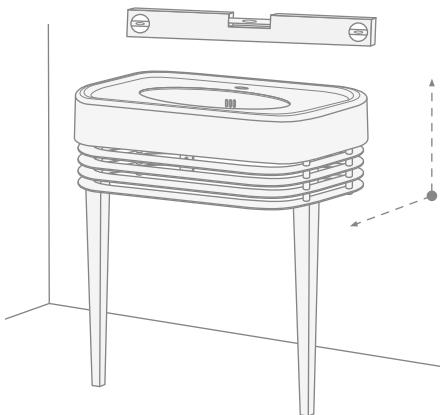
**11)** Наметить на стене 2 отверстия для крепления раковины. Снять раковину, выполнить 2 отверстия по отметкам.
