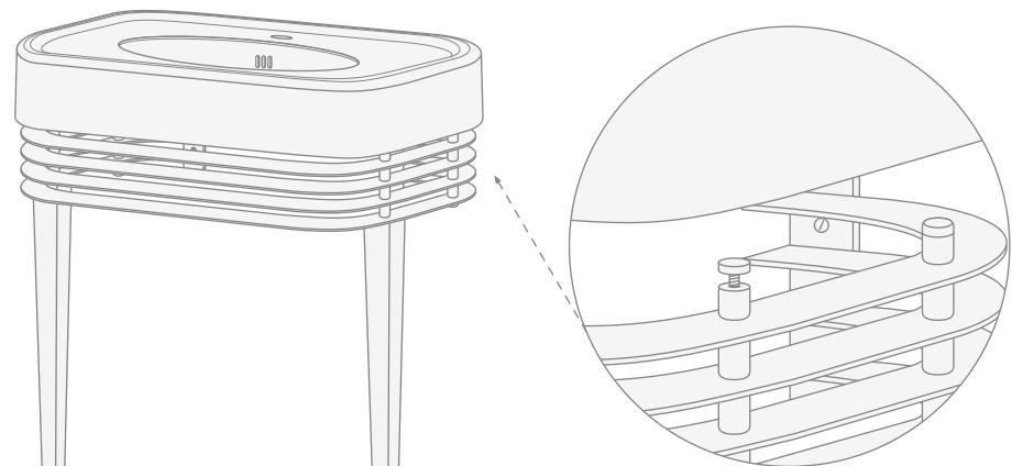
**10)** Vérifier le positionnement définitif du lavabo à l'aide d'un niveau.
