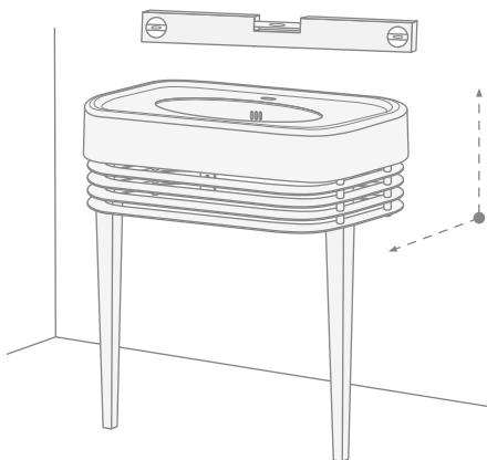
**11)** Tracer les 2 trous de fixation du lavabo au mur. Enlever le lavabo et réaliser les 2 trous en fonction du traçage.
