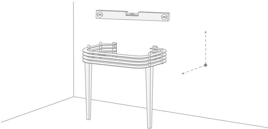
**5)** Tracer les 4 trous de fixation de la structure au mur.
