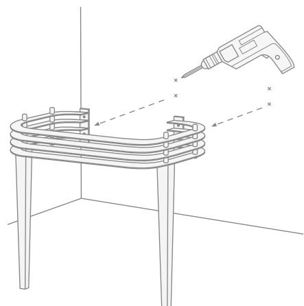
7) Вставить дюбели в отверстия, снова приставить конструкцию и прикрепить ее к стене винтами, поставляемыми в комплекте.
