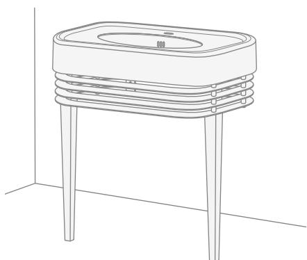
**9)** El lavabo se apoya sobre la estructura en 4 puntos; si es necesario, utilice los soportes regulables presentes en estos 4 puntos para obtener un resultado mejor.
