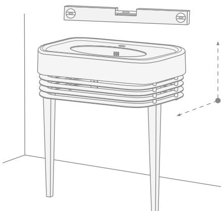
**11)** Die 2 Befestigungslöcher für das Waschbecken an der Wand anzeichnen. Das Waschbecken abnehmen und die 2 angezeichneten Löcher bohren.
