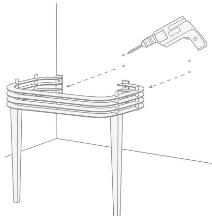
**7)** Die mitgelieferten Dübel in die Löcher einsetzen, die Struktur wieder aufstellen und mit den mitgelieferten Schrauben befestigen.
