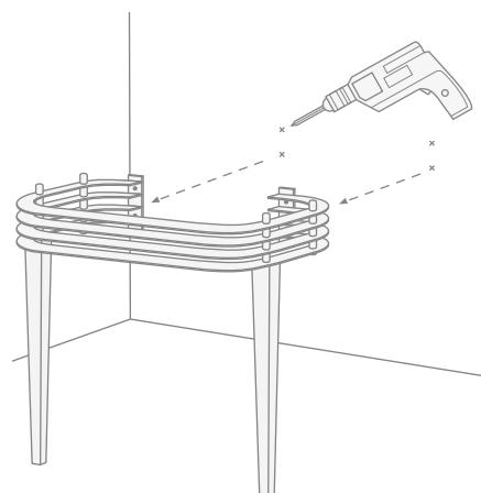
**7)** Inserire i tasselli in dotazione nei fori, posizionare di nuovo la struttura e fissarla con le viti anch'esse incluse nella dotazione.
