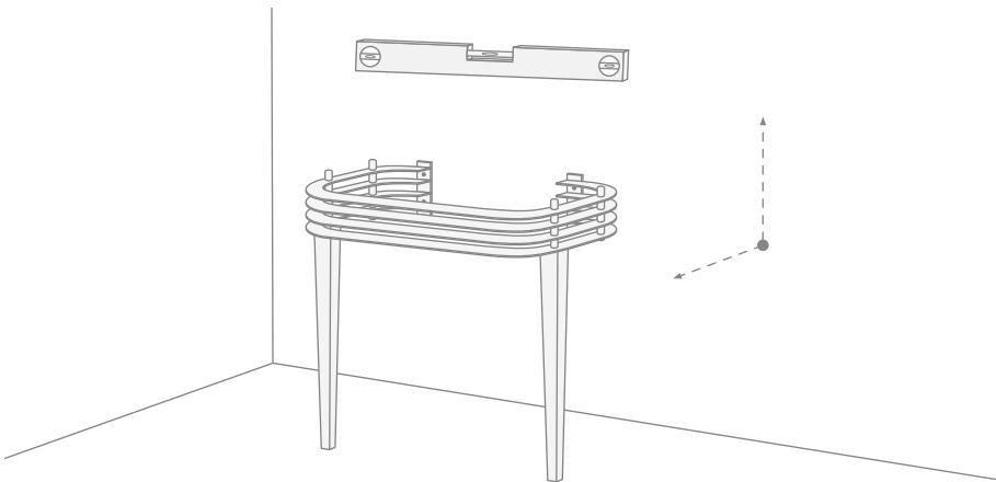
**5)** Наметить карандашом на стене места для 4 отверстий для крепления конструкции к стене.
