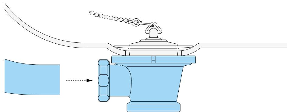
**8** Passare alla zona di scarico della vasca. Predisporre un sifone ribassato in PP (non fornito) e nel caso si rendesse necessario (vedi punto 2) un tubo flessibile in PVC (non fornito) che agevolerà il collegamento allo scarico.
