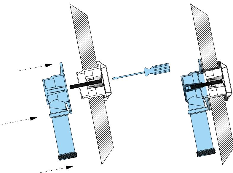
**7** Установите слив на чашу и вставьте соединительную трубку между переливом и сливом, укорачивая ее при необходимости.
