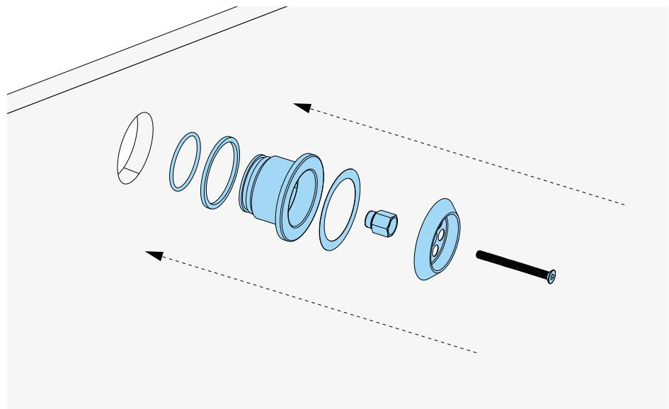
**5** Для установки второй части комплекта обвязки снимите защитную бумагу с уплотнительной прокладки, затем сожмите все элементы в указанном здесь порядке.
