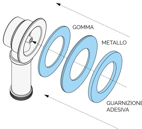
**6** Avvitare le due parti della colonna di scarico. N.B.: per eseguire questa operazione in modo corretto, è indispensabile premere bene la scocca durante il posizionamento della seconda parte.
