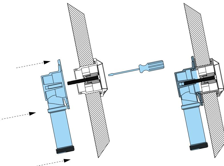
**7** Installare la piletta di scarico - in finitura - sull'invaso, e immettere il tubo di collegamento tra il troppo pieno e la piletta, accorciandolo secondo necessità.
